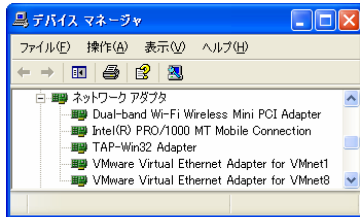
図 3-13 仮想ネットワークデバイスの削除
