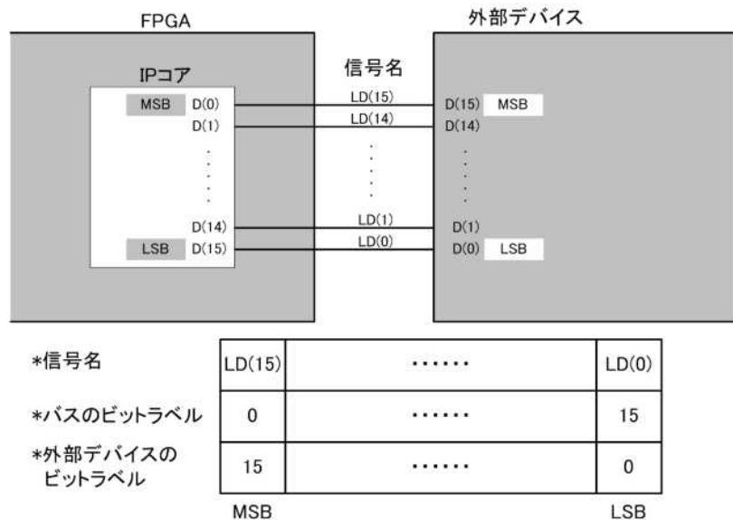
図 6.1. CoreConnect のビットラベルと信号名
