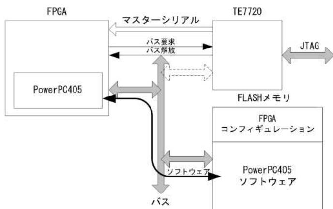
FPGAのコンフィギュレーション完了後、PowerPC405がFLASHメモリを使用
