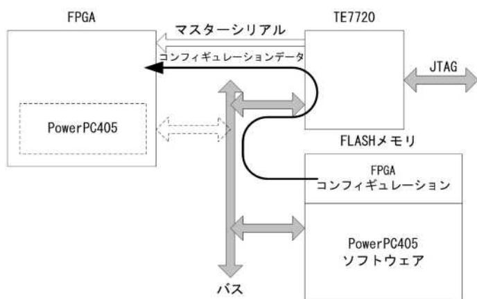
電源投入時FLASHメモリからTE7720経由でFPGAをコンフィギュレーション
