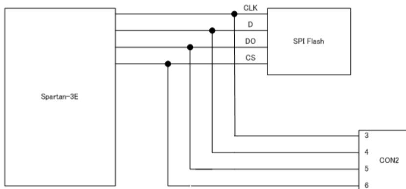
図 4.6. FPGA コンフィギュレーション
