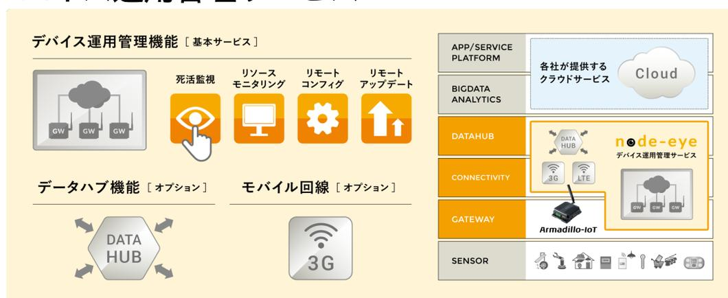
node-eye は、IoT ゲートウェイの稼働状況を確認するためのリソースの監視・管理機能、ファームウェアの機能追加やバグ修正に対応するリモートアップデート機能など、IoT ゲートウェイの基本的な運用・管理機能を一括して提供するサービスです。アットマークテクノ製「Armadillo-IoT（アルマジロ・アイ・オー・ティ）ゲートウェイ」専用のサービスのため、ポータリングの手間をかけることなくすぐにスタートアップでき、ビジネス価値の創造に役立つアプリケーション開発により集中することが可能です。
