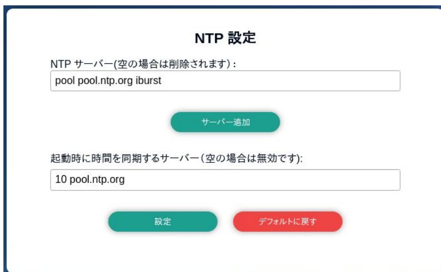
図 6.110 ネットワークタイムサーバーの設定項目
