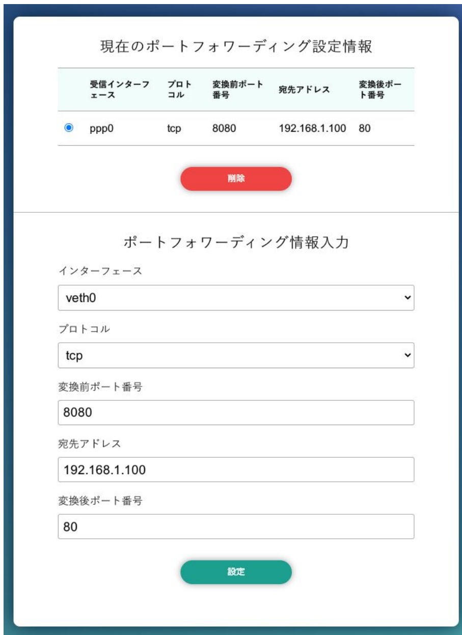
図 3.139 LTE からの受信パケットに対するポートフォワーディング設定
