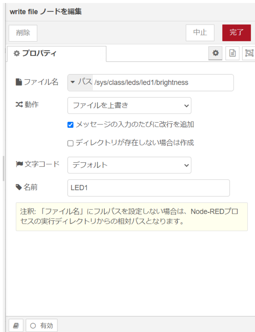
図 4.5 [write file] ノードのプロパティ内容
