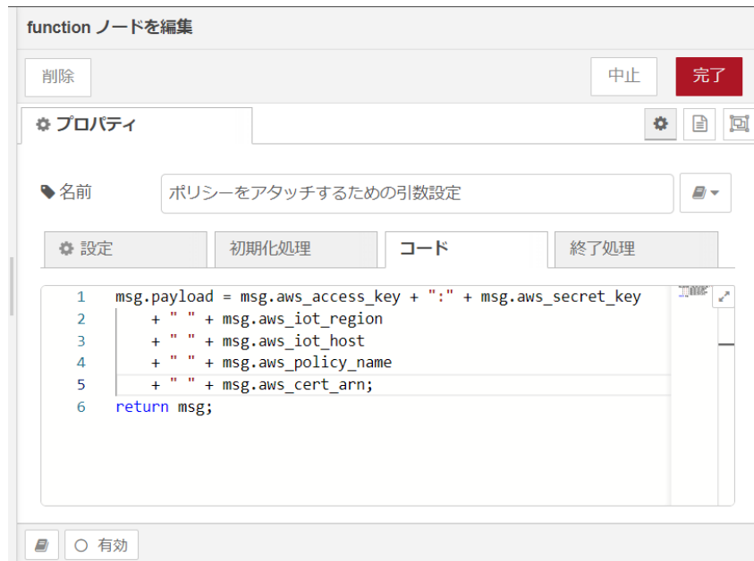
図 4.54 [ポリシーをアタッチするための引数設定] ノードのプロパティ内容
