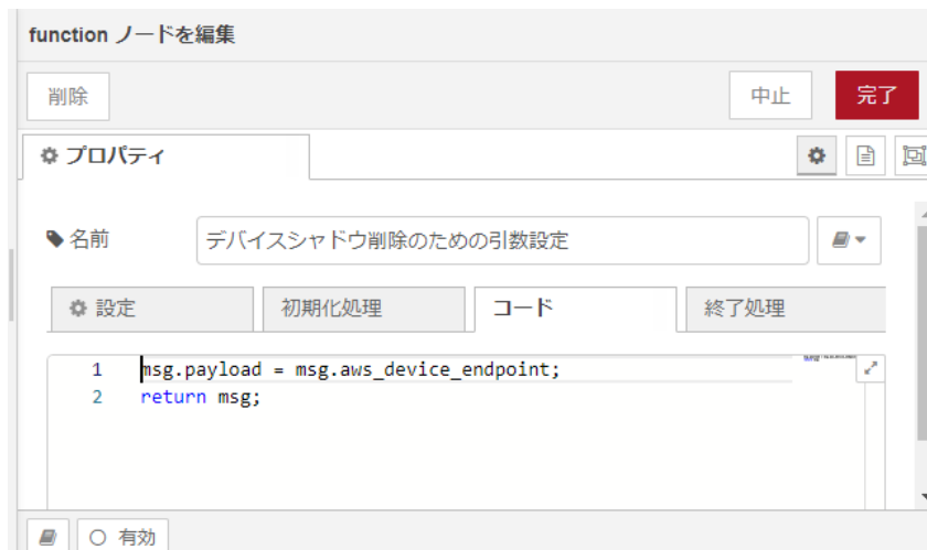
図 4.70 [デバイスシャドウ削除のための引数設定] ノードのプロパティ内容
