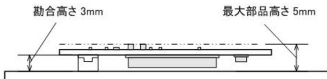
図 5.2. プラットフォームボードとの接続状態図
