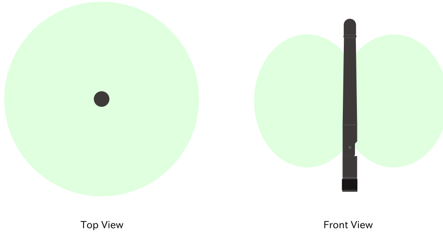
図 5.1 無線 LAN/BT 用外付けアンテナの指向性
