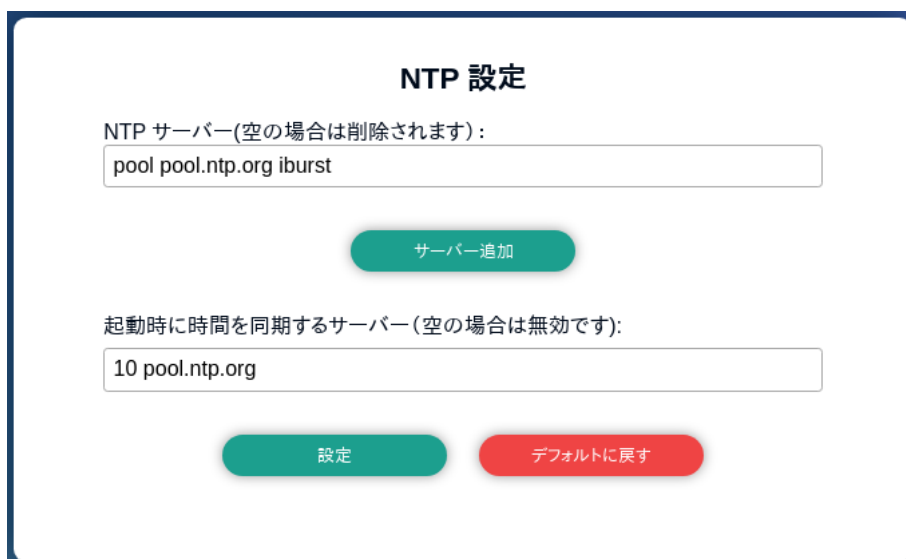
図 6.95 ネットワークタイムサーバーの設定項目
