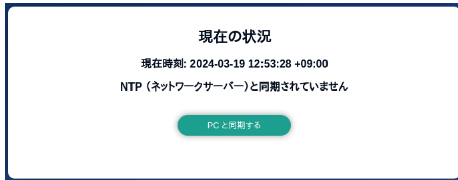
図 6.104 ネットワークタイムサーバーと同期されていない場合の状況確認画面
