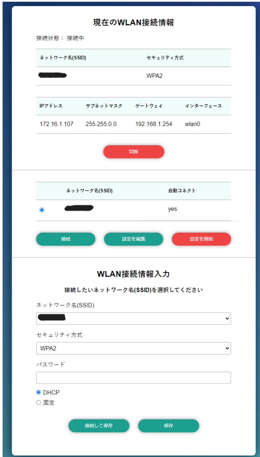
図 3.109 WLAN クライアント設定画面
