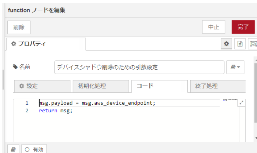
図 4.72 [デバイスシャドウ削除のための引数設定] ノードのプロパティ内容
