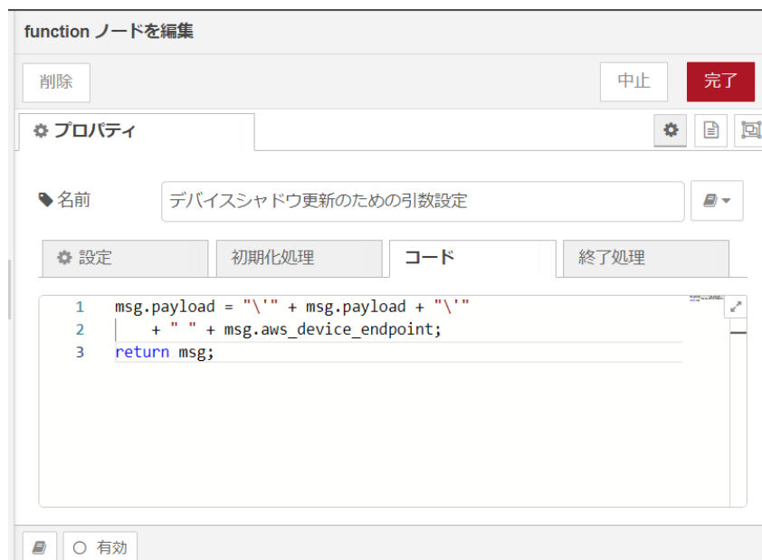
図 4.67 [デバイスシャドウ更新のための引数設定] ノードのプロパティ内容
