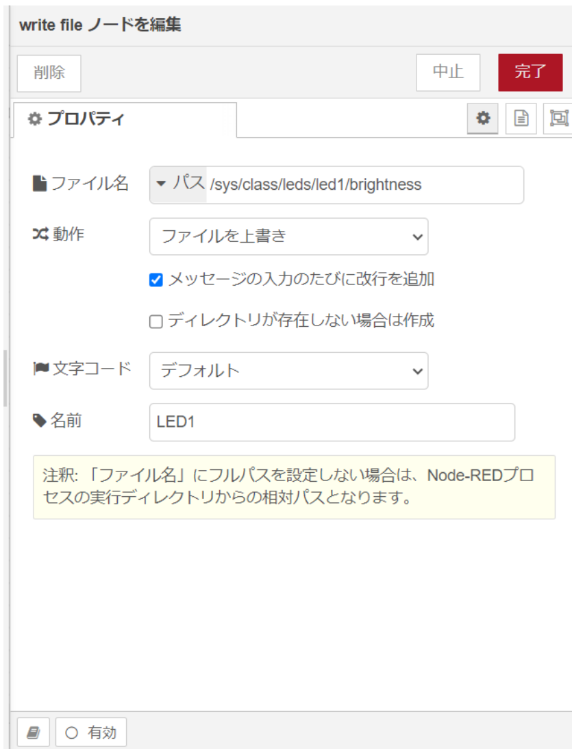
図 4.5 [write file] ノードのプロパティ内容
