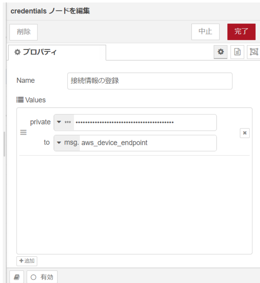
図 4.64 [接続情報の登録] ノードのプロパティ内容
