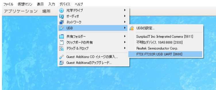
図 4.8 ATDE にデバイスを接続する
