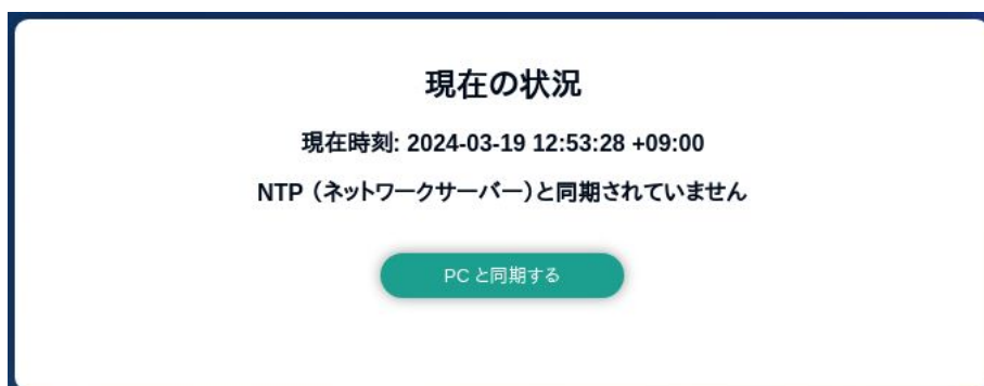
図 6.111 ネットワークタイムサーバーと同期されていない場合の状況確認画面
