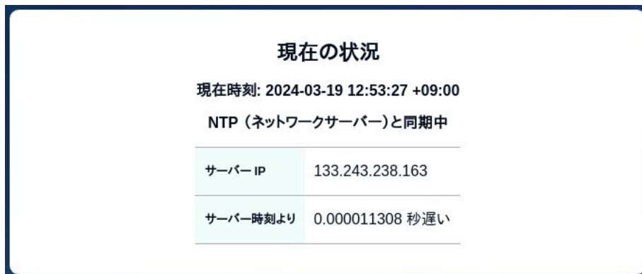
図 6.110 ネットワークタイムサーバーと同期されている場合の状況確認画面
