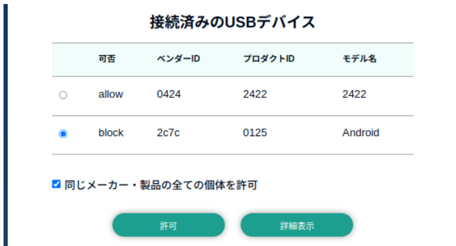
図 3.215 接続済みの個体と同じメーカー・製品の全ての個体を許可する
