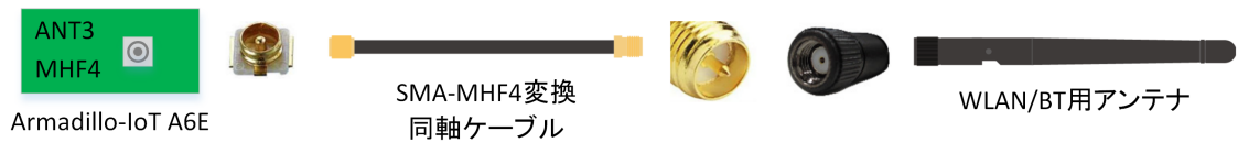
図 3.49 ANT3 RP-SMA 端子のアンテナ接続例
