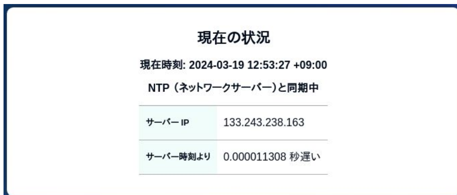
図 6.97 ネットワークタイムサーバーと同期されている場合の状況確認画面
