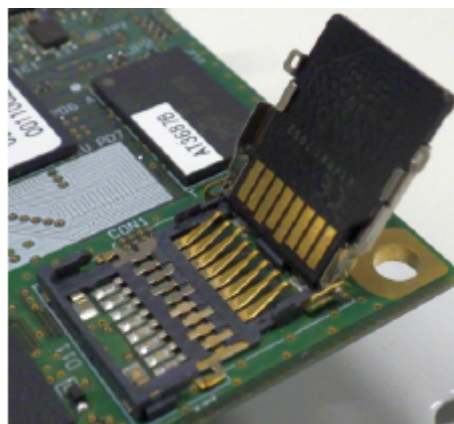
図 3.70 microSD カードの挿抜
