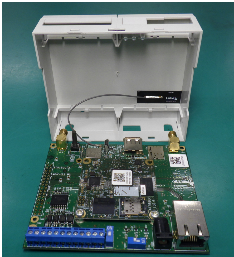
図 3.62 WLAN 基板アンテナの位置
