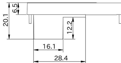
図 6.225 形状図 カバーパーツ C
