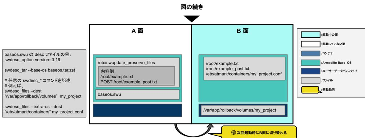
図 6.18 B 面への切り替え (component=base\_os)
