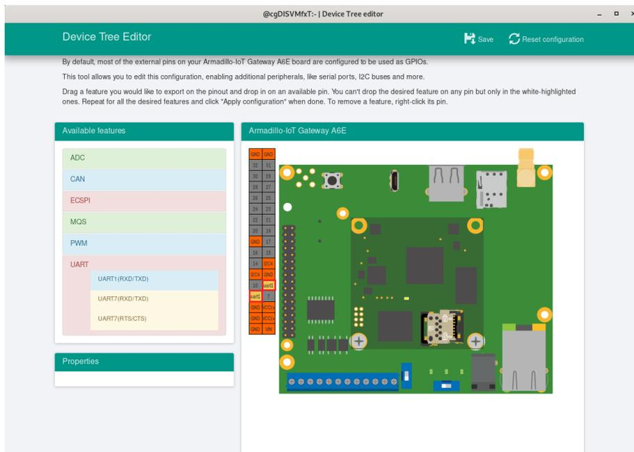
図 6.194 CON8 8/9 ピンへのドロップ
