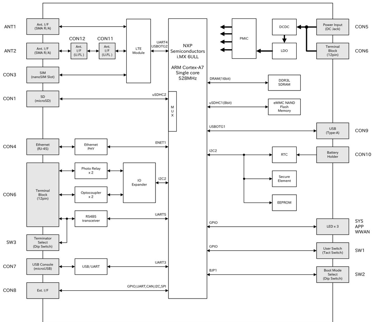
図 2.13 ブロック図(AG6261-C01Z,AG6261-U01Z,AG6261-U00Z)
