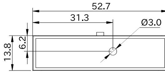
図 6.222 形状図 カバーパーツ A (アンテナ穴無し)
