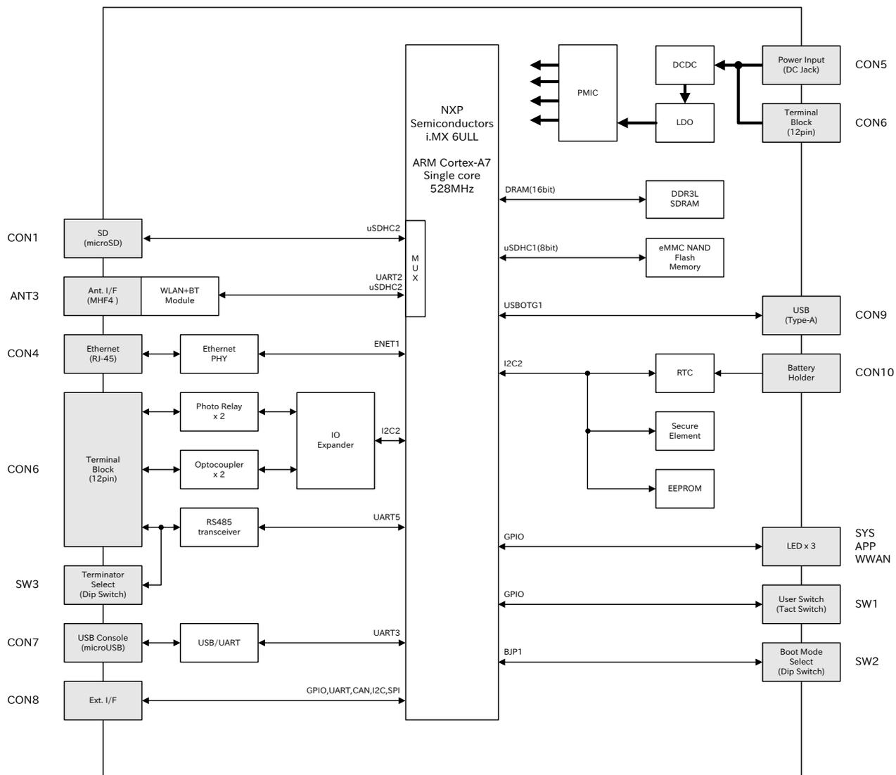
図 2.15 ブロック図(AG6211-C02D0,AG6211-C02Z,AG6211C00Z,AG6211-U02Z,AG6211-U00Z)
