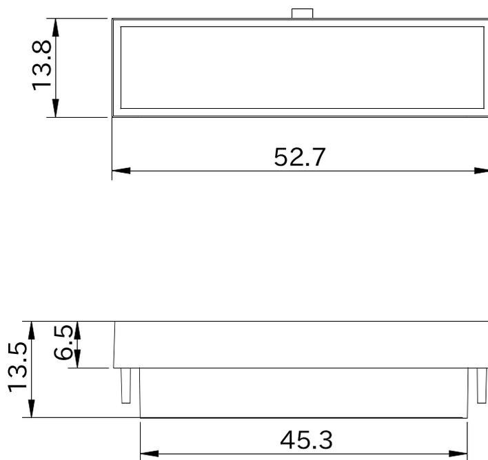
図 6.226 形状図 カバーパーツ D
