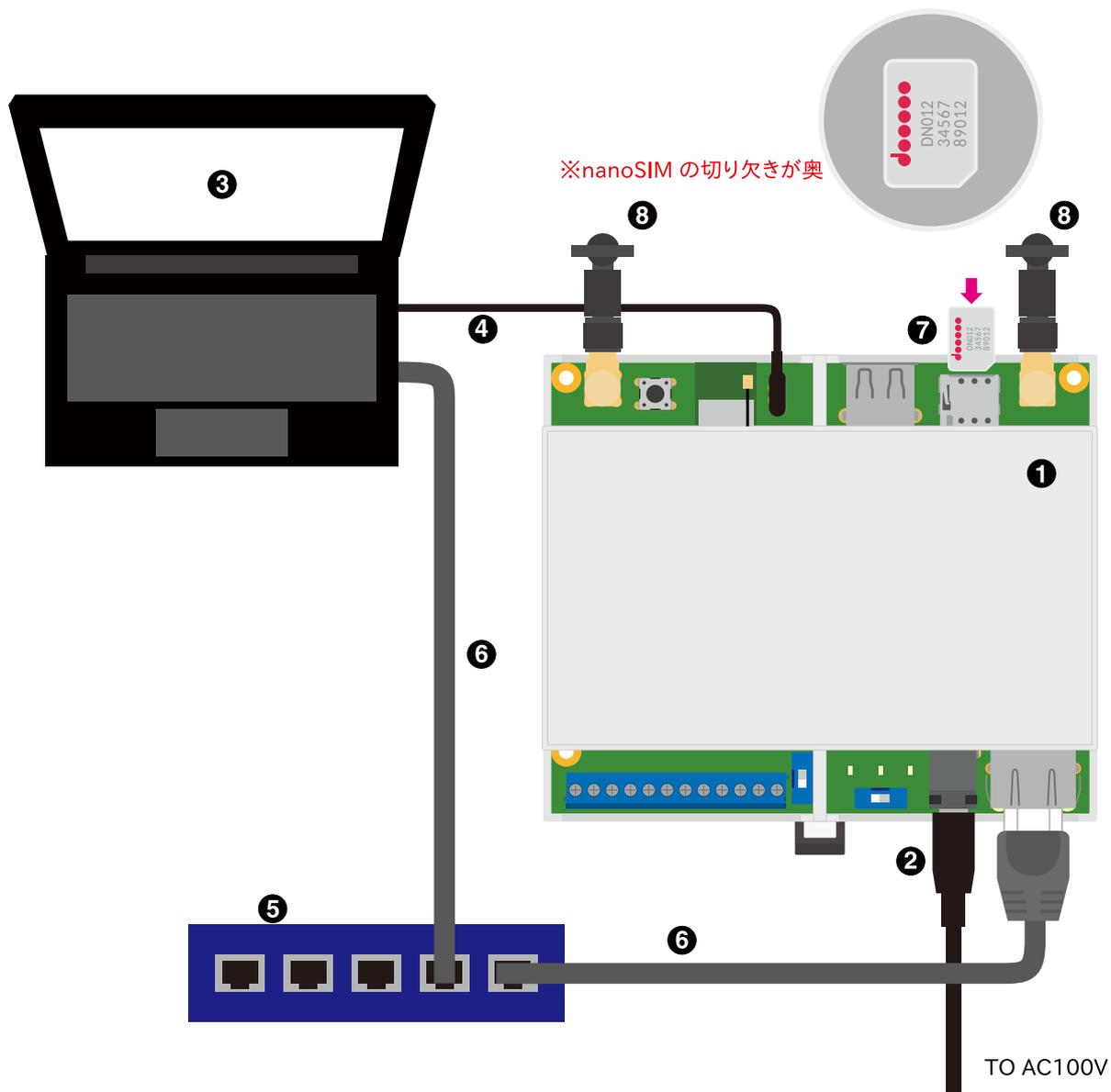
図 3.14 Armadillo-IoT ゲートウェイ A6E の接続例
