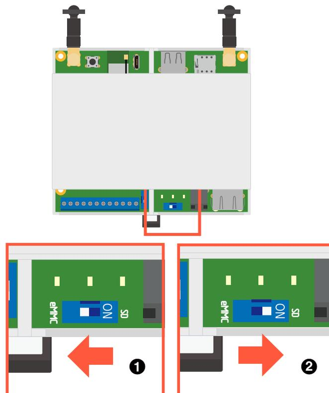
図 3.15 起動デバイス設定スイッチの操作
