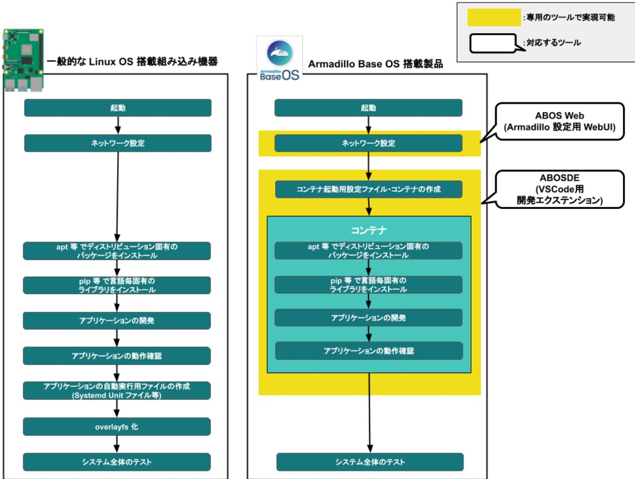
Armadillo Base OS 搭載機器上で動作するソフトウェアの開発は、基本的に作業用 PC 上で行います。ネットワークの設定は ABOS Web という機能で、コマンドを直接打たずとも設定可能です。
