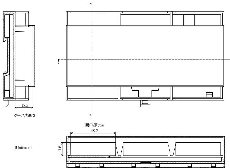
図 6.220 形状図 ケース内高さおよび開口部寸法
