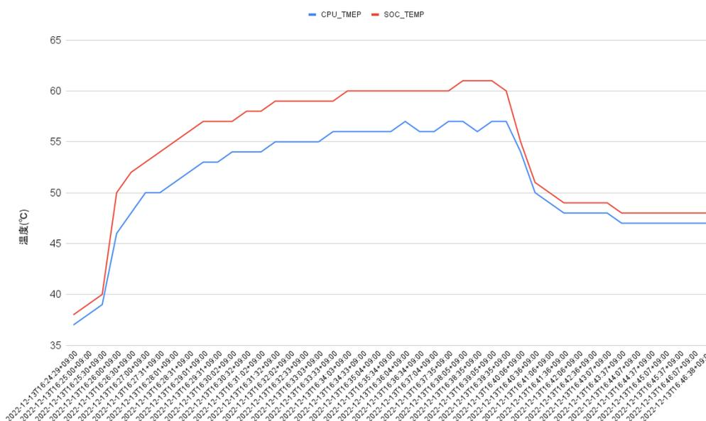
図 6.179 Armadillo-IoT ゲートウェイ G4 で取得した温度のグラフ
