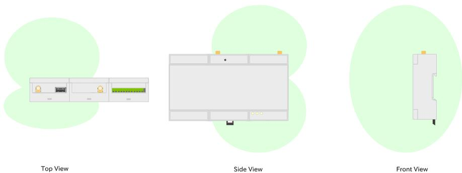
図 5.1 Armadillo-IoT ゲートウェイ A6E WLAN+BT アンテナの指向性
