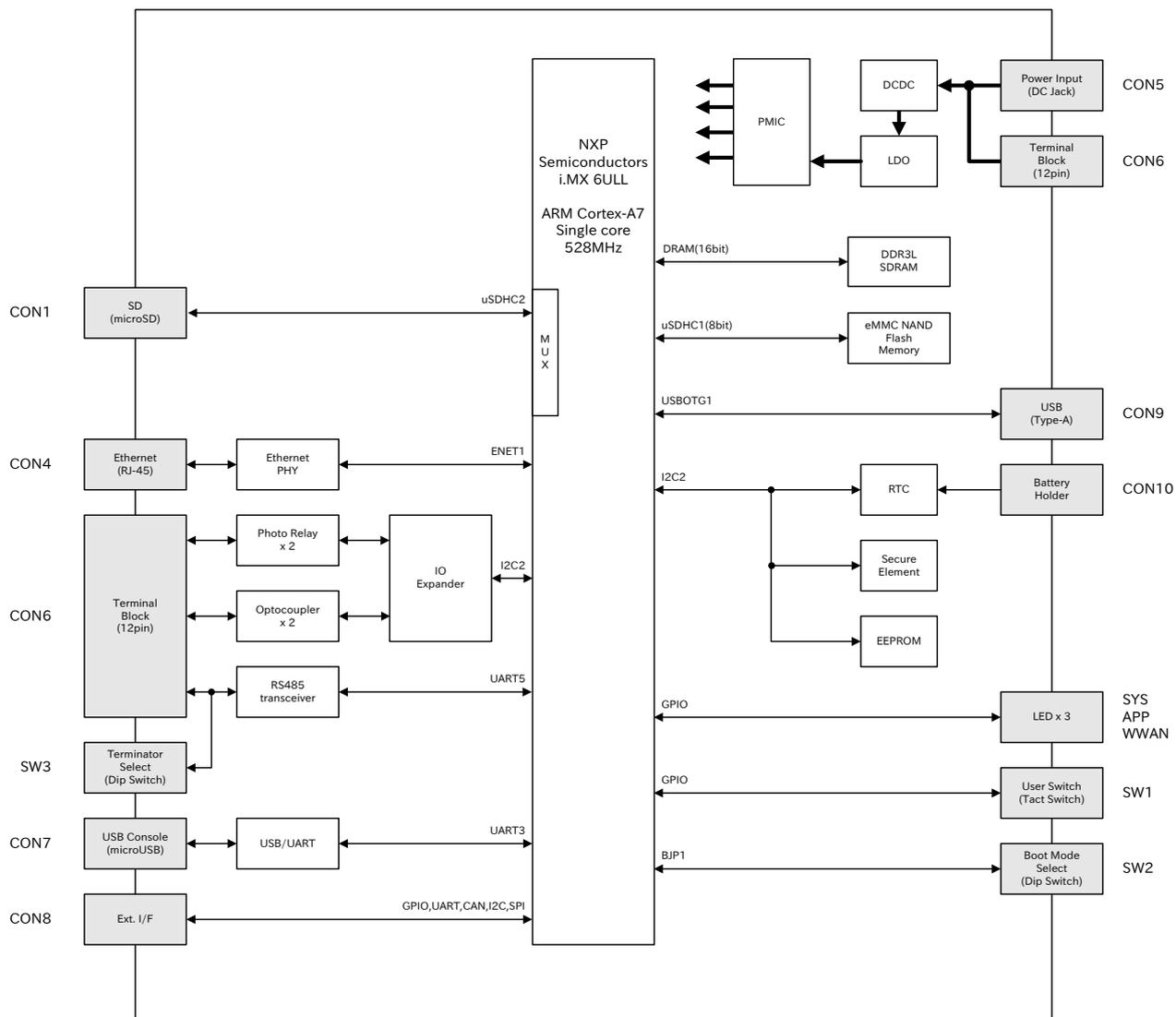
図 2.16 ブロック図(AG6201-C00Z,AG6201-U00Z)
