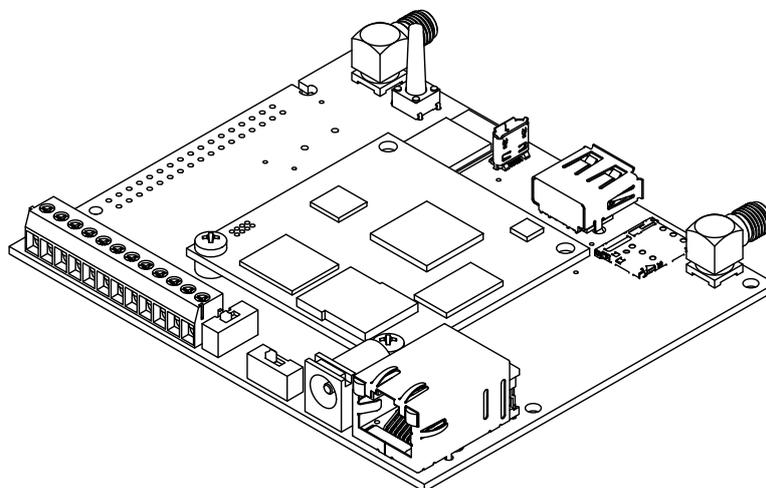
図 2.10 Armadillo-IoT ゲートウェイ A6E 量産ボード
