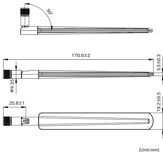
図 3.33 LTE アンテナ形状図
