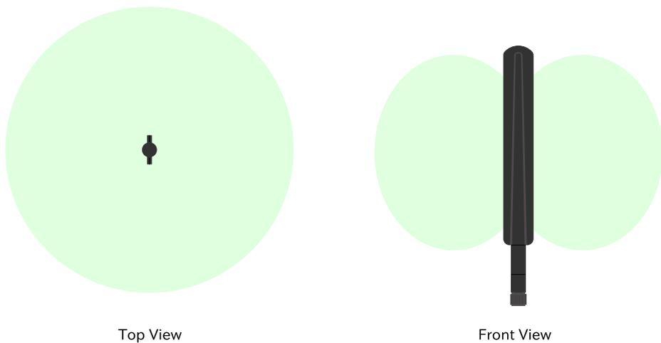
図 5.2 LTE 外付け用アンテナの指向性
