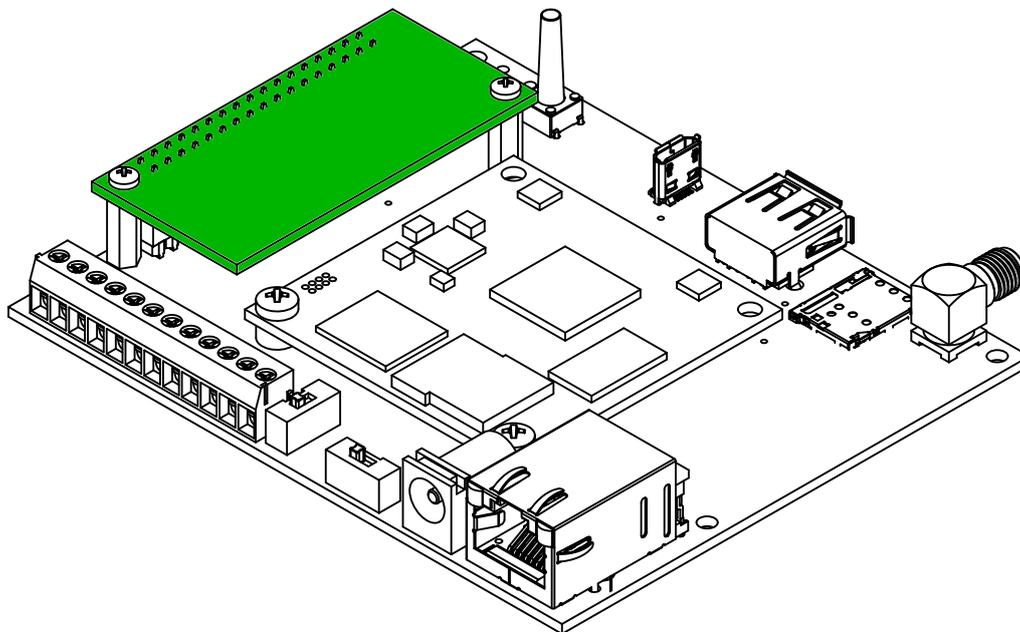
図 3.21 垂直方向に拡張基板を配置した場合の接続例
