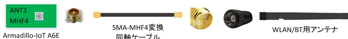
図 3.49 ANT3 RP-SMA 端子のアンテナ接続例
