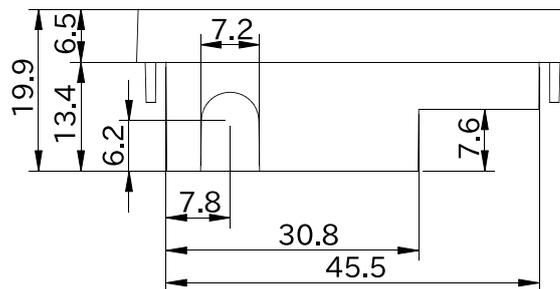
図 6.223 形状図 カバーパーツ B (アンテナ穴有り)
