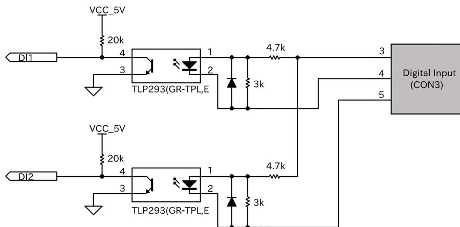
図 3.69 CON6 接点入力周辺回路
