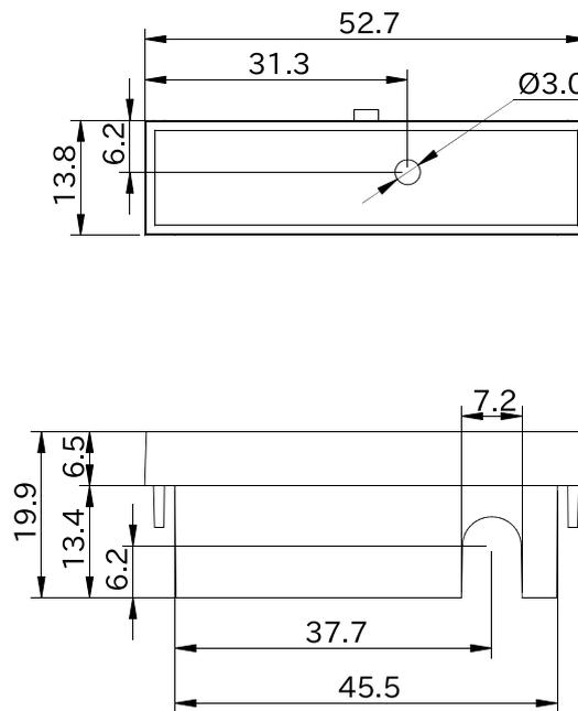
図 6.221 形状図 カバーパーツ A (アンテナ穴有り)
