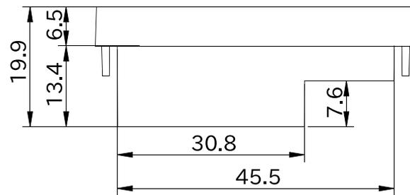
図 6.224 形状図 カバーパーツ B (アンテナ穴無し)
