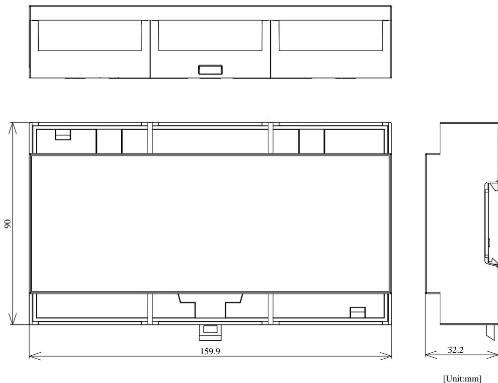
図 6.219 形状図 ケース外形(トップとボトムを組み合わせた状態)
