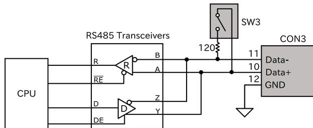
図 3.78 CON6 RS485 トランシーバ周辺回路
