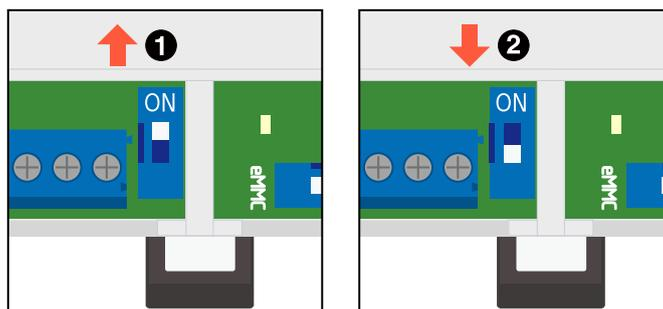
図 3.79 スイッチの状態と終端抵抗の ON/OFF
