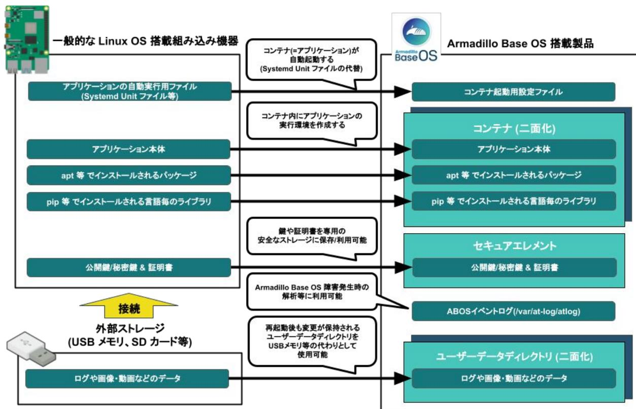
Linux OS 搭載組み込み機器ではアプリケーションの実行環境をユーザーランド上に直接用意し、Systemdなどでアプリケーションを自動実行させるのが一般的です。Armadillo Base OS 搭載機器では、アプリケーションの実行環境をコンテナ内に用意して、コンテナ起動用設定ファイルを所定の場所に配置することでコンテナ(=アプリケーション)を自動実行させます。
