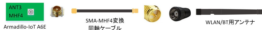
図 14.21 ANT3 RP-SMA 端子のアンテナ接続例
