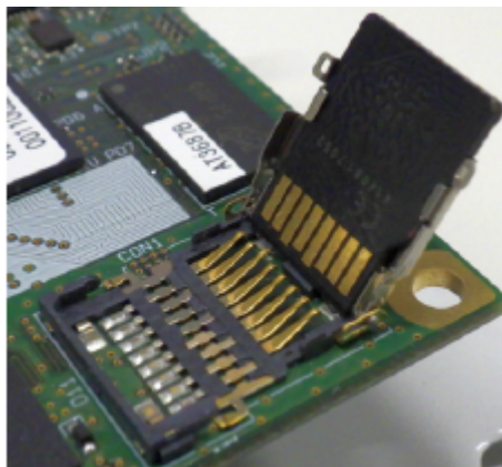
図 3.16 microSD カードの挿抜
