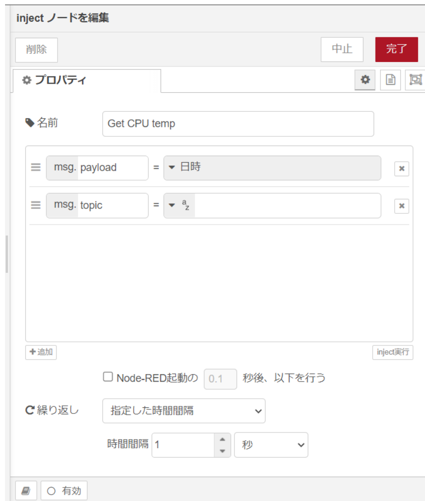
図 4.7 [inject] ノードのプロパティ内容
