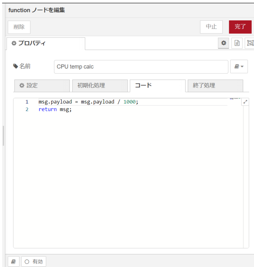
図 4.9 [function] ノードのプロパティ内容
