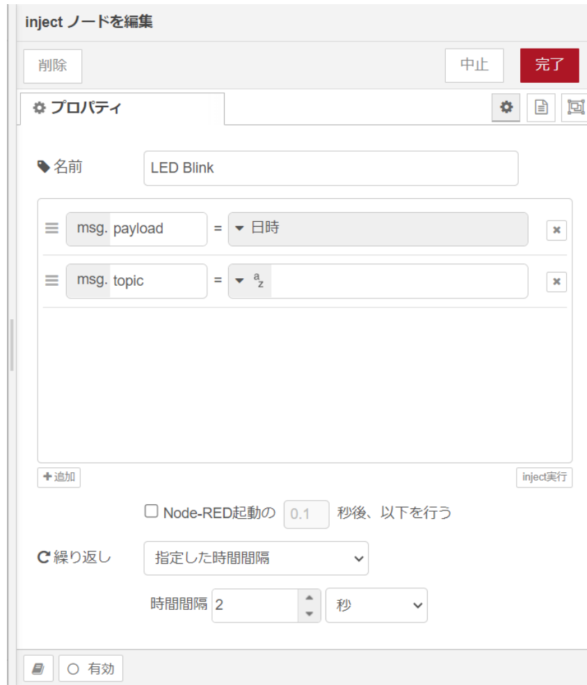
図 4.3 [inject] ノードのプロパティ内容
