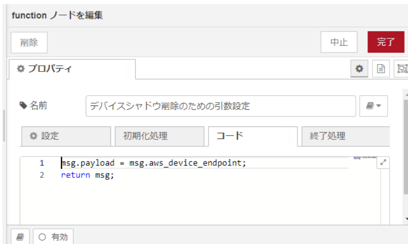
図 4.91 [デバイスシャドウ削除のための引数設定] ノードのプロパティ内容
