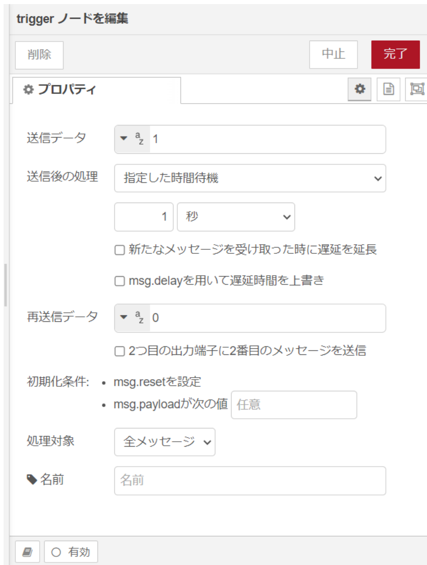
図 4.18 [trigger] ノードのプロパティ内容
