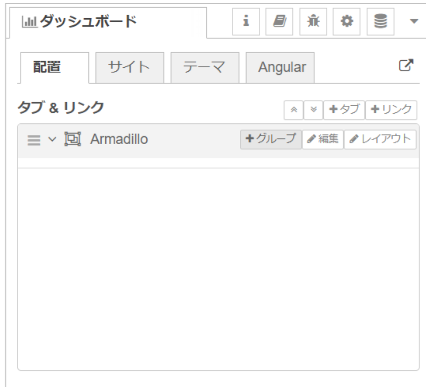
図 4.39 ダッシュボード編集画面に [Armadillo] タブが追加
