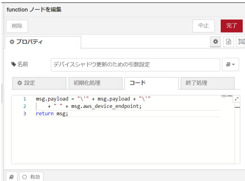
図 4.86 [デバイスシャドウ更新のための引数設定] ノードのプロパティ内容
