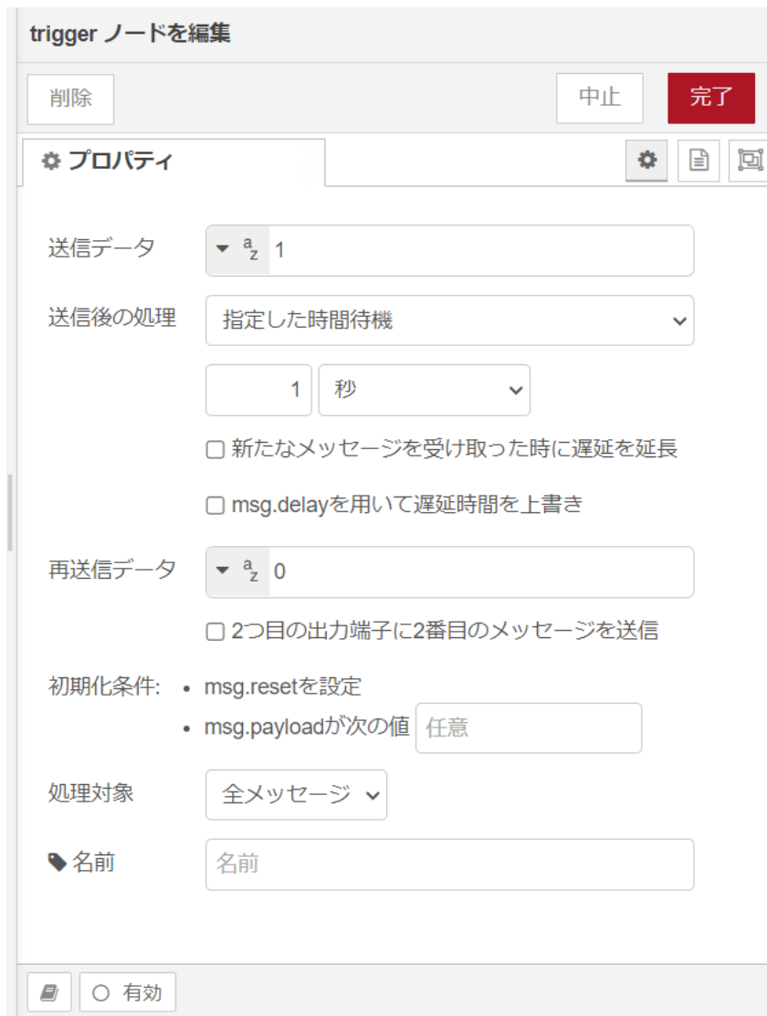
図 4.4 [trigger] ノードのプロパティ内容
