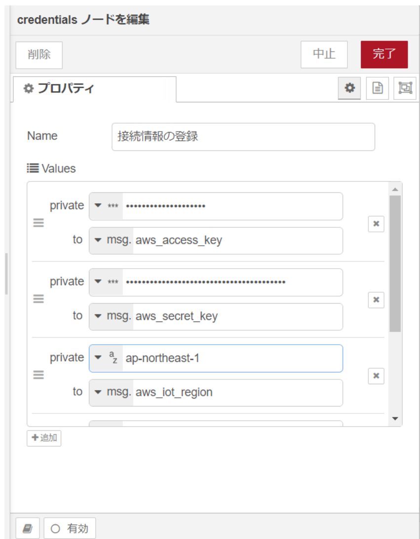
図 4.74 [接続情報の登録] ノードのプロパティ内容
