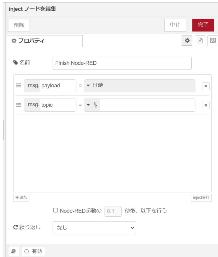
図 4.48 [inject] ノードのプロパティ内容
