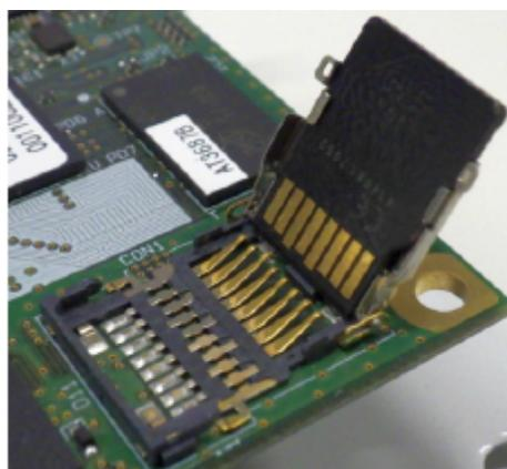
図 3.15 microSD カードの挿抜
