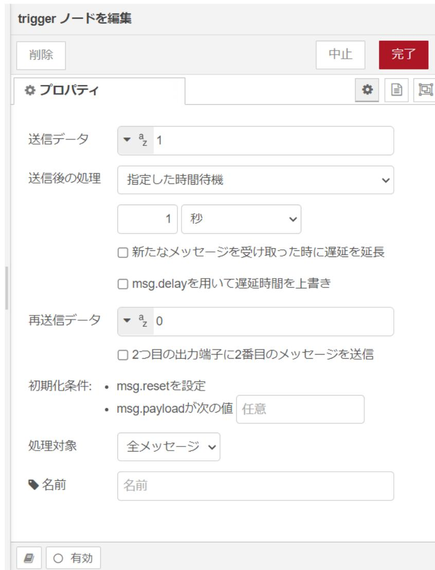
図 4.18 [trigger] ノードのプロパティ内容
