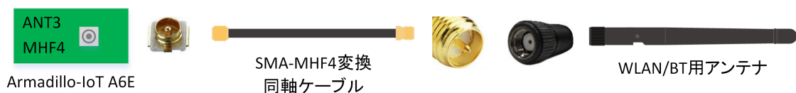
図 3.79 ANT3 RP-SMA 端子のアンテナ接続例
