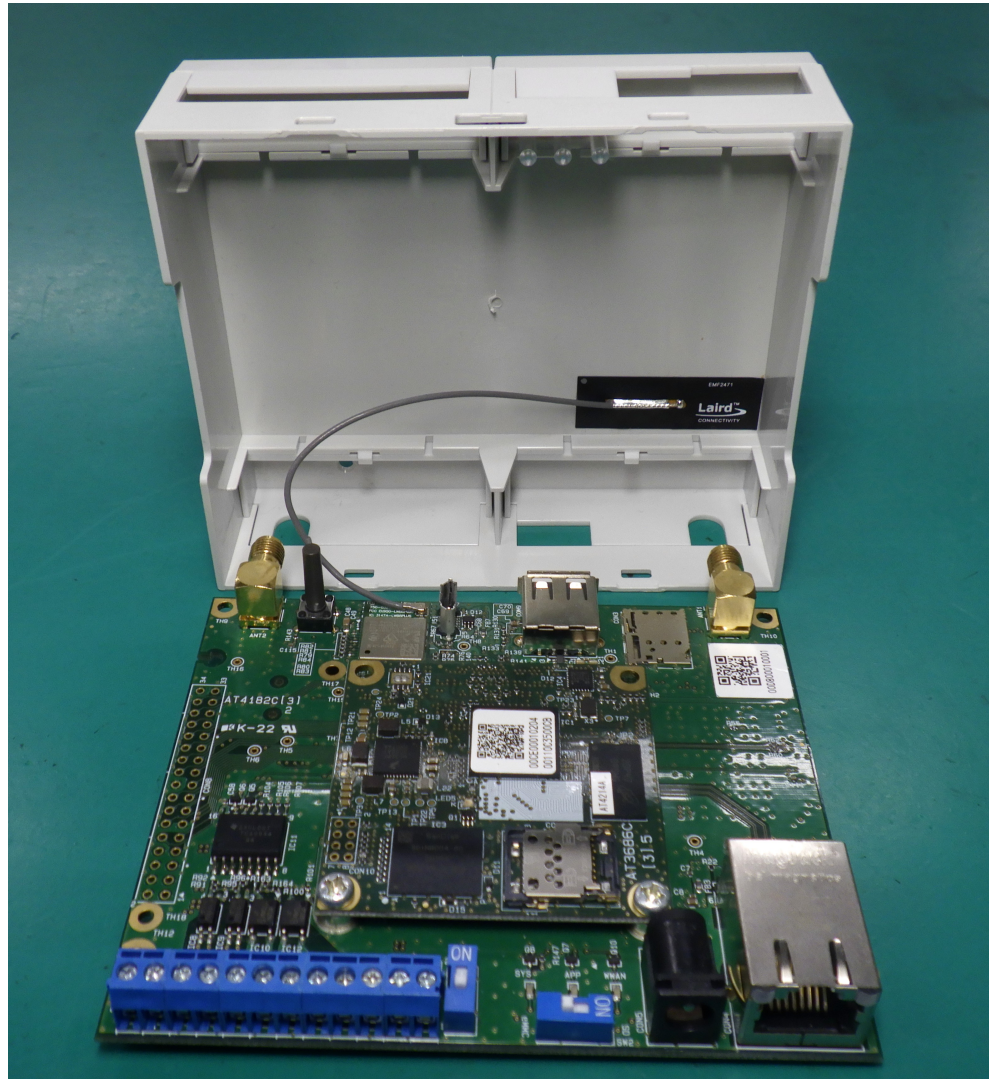
図 3.58 WLAN 基板アンテナの位置
