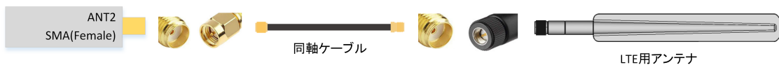
図 3.78 ANT2 50Ω 同軸ケーブルでの延長例(LTE アンテナインターフェース)
