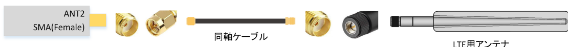
図 3.45 ANT2 50Ω 同軸ケーブルでの延長例(LTE アンテナインターフェース)
