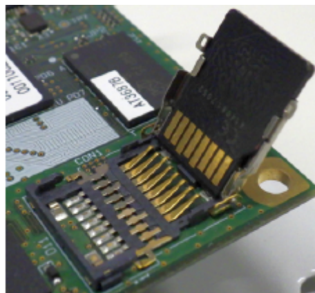
図 3.34 microSD カードの挿抜
