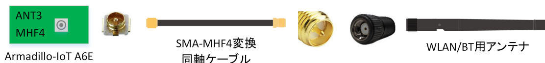
図 3.39 ANT3 RP-SMA 端子のアンテナ接続例
