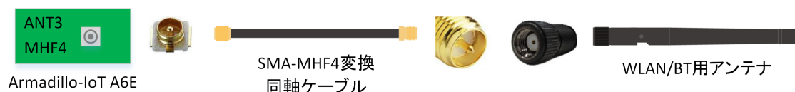
図 3.39 ANT3 RP-SMA 端子のアンテナ接続例
