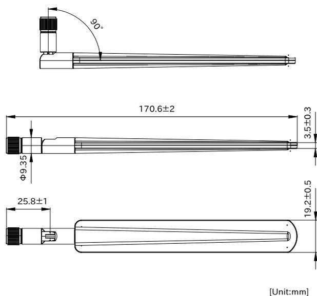
図 3.61 LTE 用外付けアンテナ形状図
