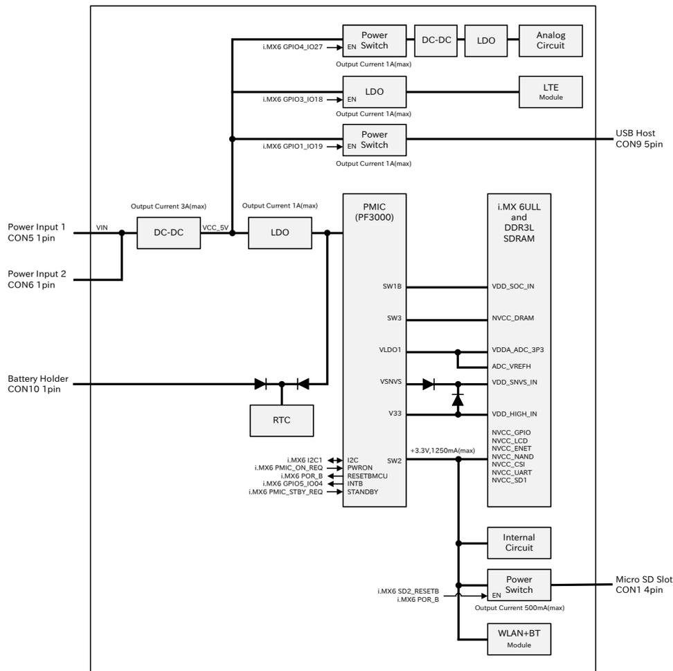
図 3.53 電源回路の構成
