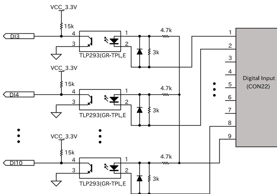
図 3.109 CON22 接点入力周辺回路
