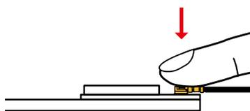
図 3.73 WLAN 基板アンテナの手による取り付け
