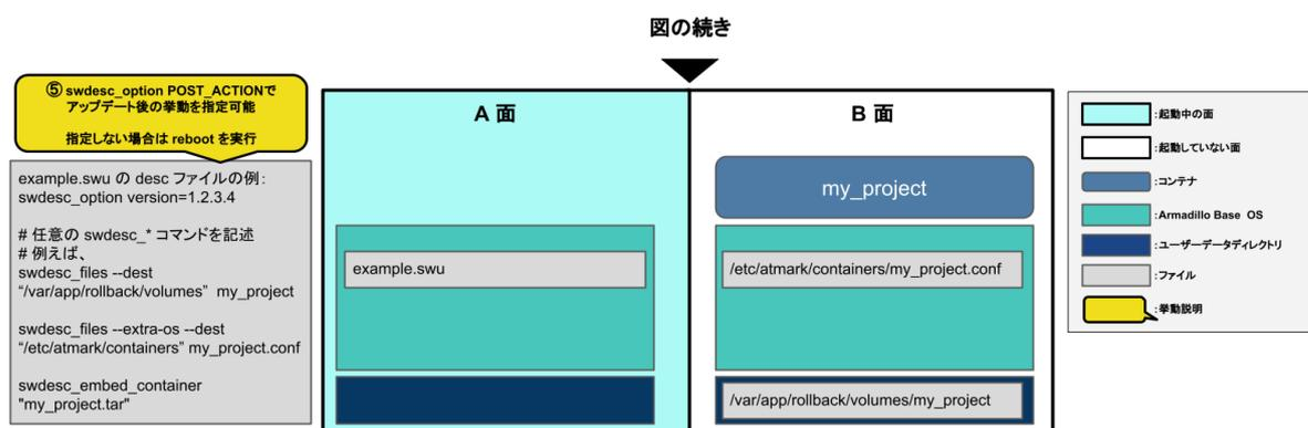
図 6.24 アップデート完了後の挙動
