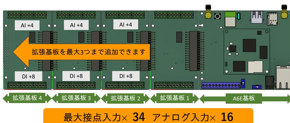
図 3.159 +Di8+Ai4 拡張基板のカスケード接続
