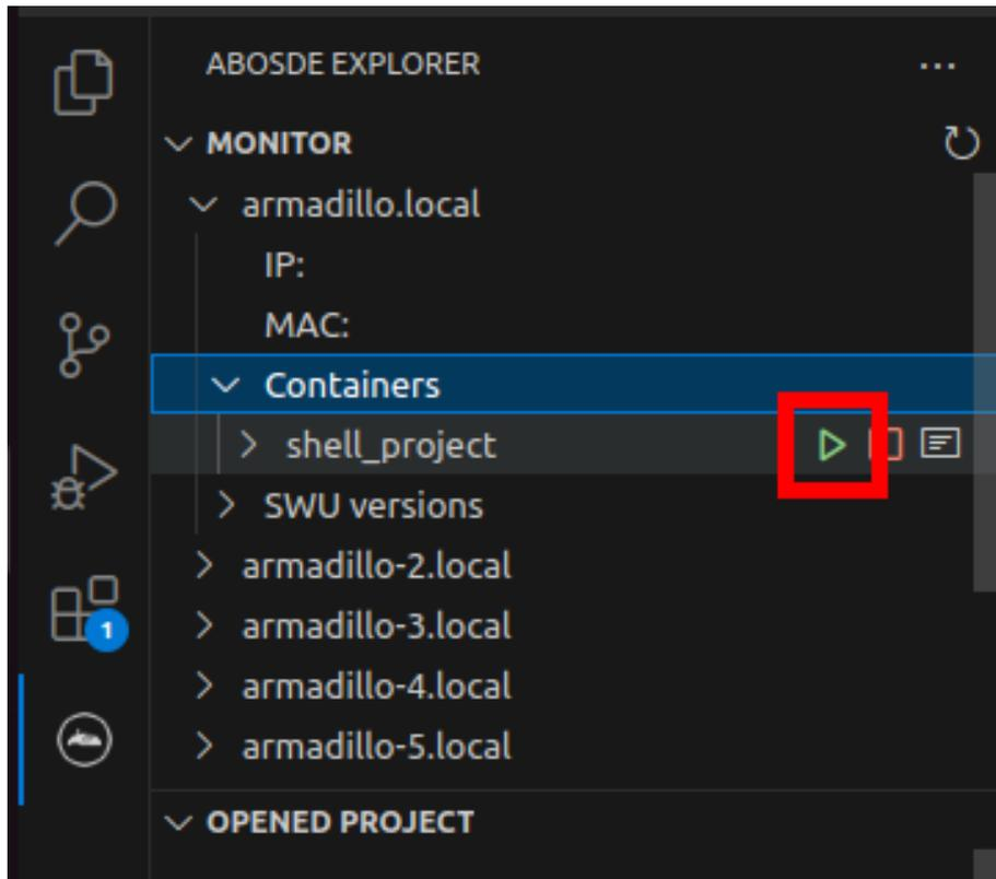
図 6.124 ABOSDE で Armadillo のコンテナを起動
