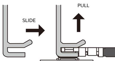
図 3.74 WLAN 基板アンテナの挿抜治具による取り外し
