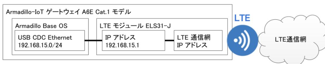
図 6.148 Cat.1 モデル (ELS31-J) LTE ネットワーク構成
