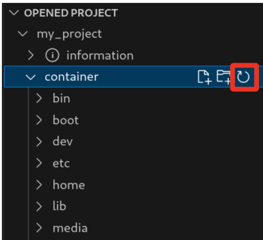
図 3.273 コンテナ内のファイル一覧を再表示するボタン
