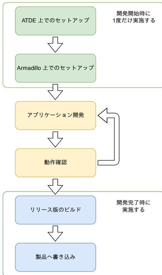
図 3.204 ゲートウェイコンテナアプリケーション開発の流れ
