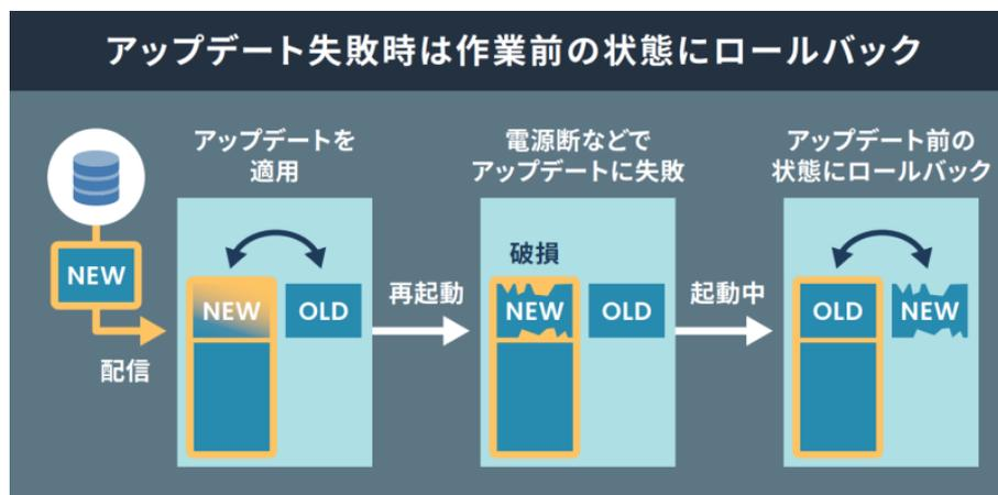
図 2.6 ロールバックの仕組み
