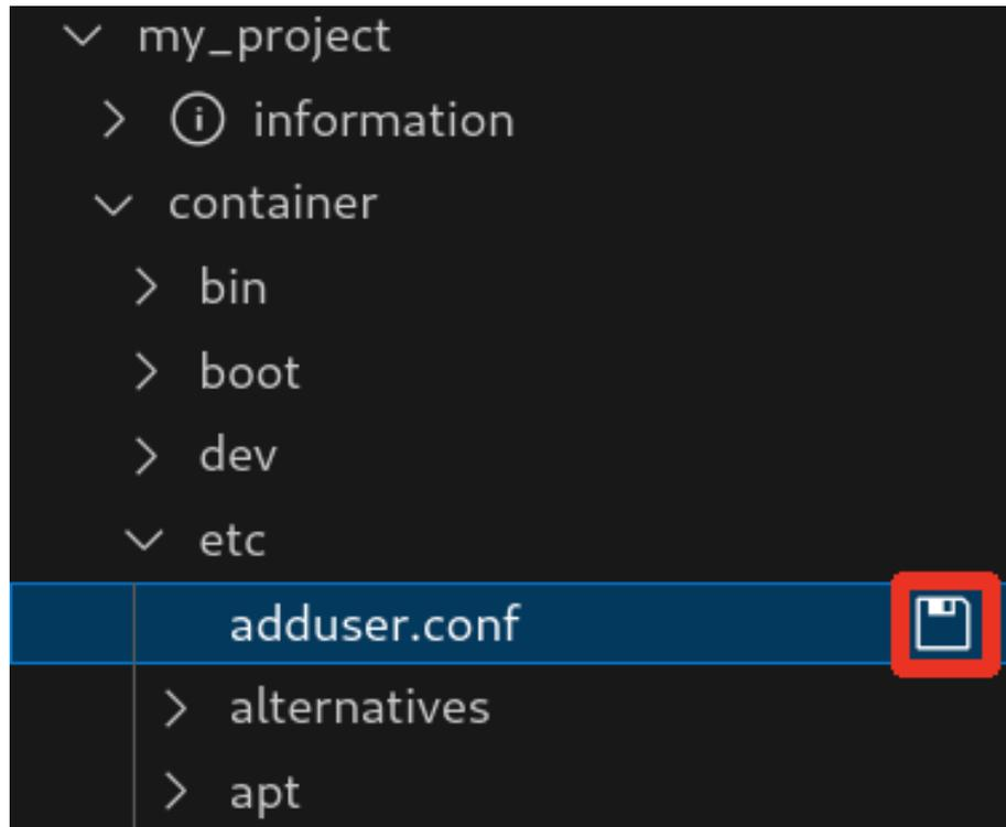
図 3.280 コンテナ内のファイルを container/resources 下に保存するボタン
