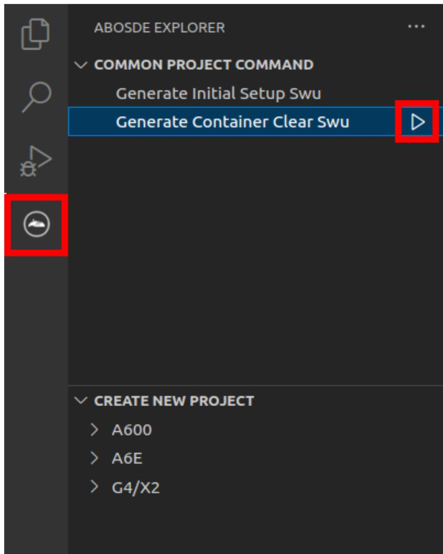
図 6.62 Armadillo 上のコンテナイメージを削除する
