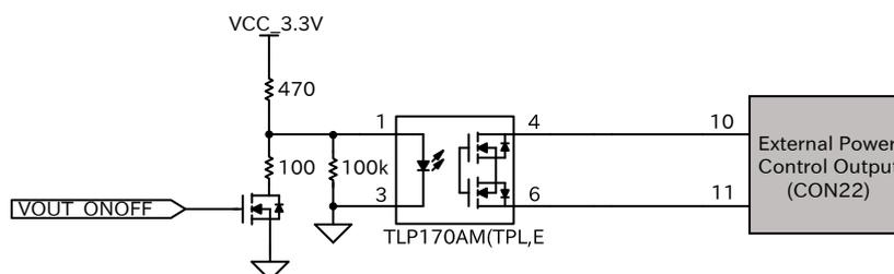
図 3.155 CON22 外部電源制御出力周辺回路
