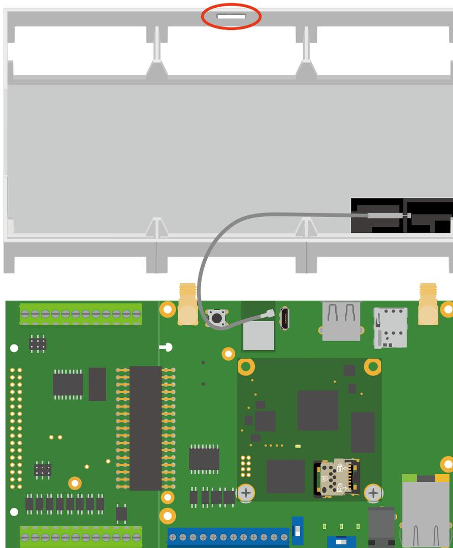
図 3.75 WLAN 基板アンテナの貼り付け位置
