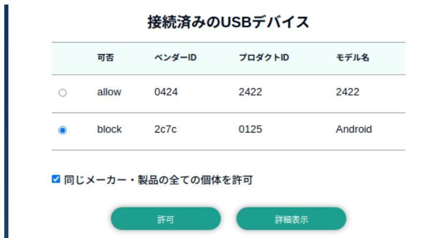
図 3.193 接続済みの個体と同じメーカー・製品の全ての個体を許可する
