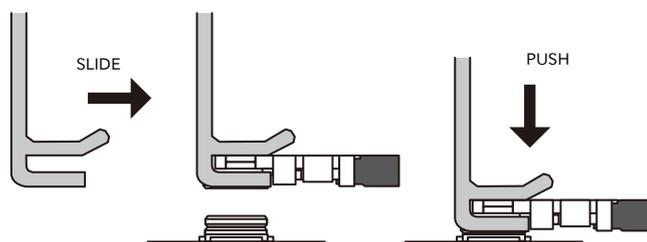
図 3.71 WLAN 基板アンテナの挿抜治具による取り付け
