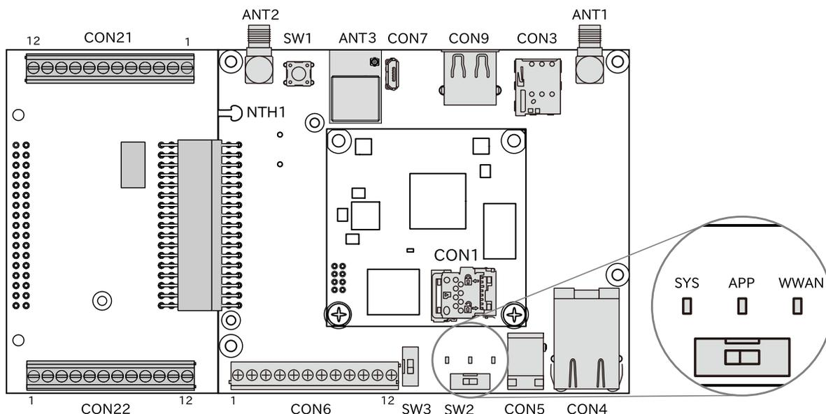
図 3.77 Armadillo-IoT ゲートウェイ A6E +Di8+Ai4 のインターフェース 表面
