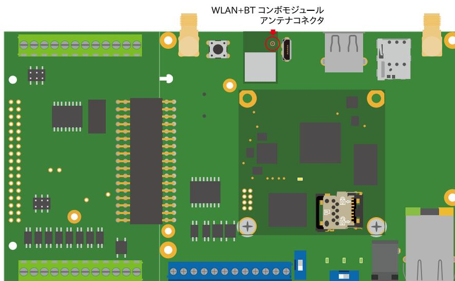
図 3.69 WLAN+BT コンボモジュールのアンテナコネクタの位置
