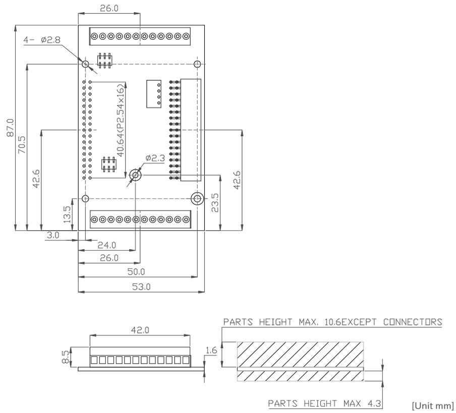
図 6.261 +Di8+Ai4 拡張基板基板形状図
