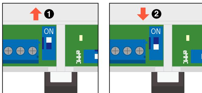
図 3.119 スwitchの状態と終端抵抗の ON/OFF
