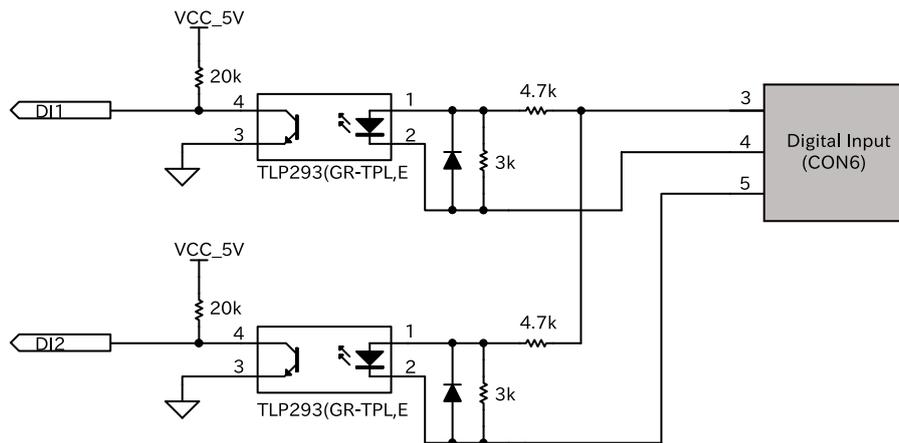
図 3.108 CON6 接点入力周辺回路
