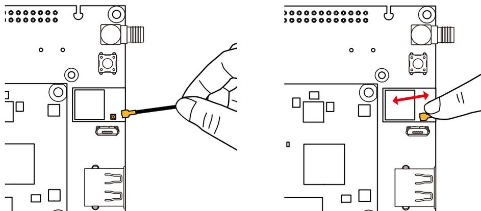
図 3.72 WLAN 基板アンテナの手による取り付け前の準備
