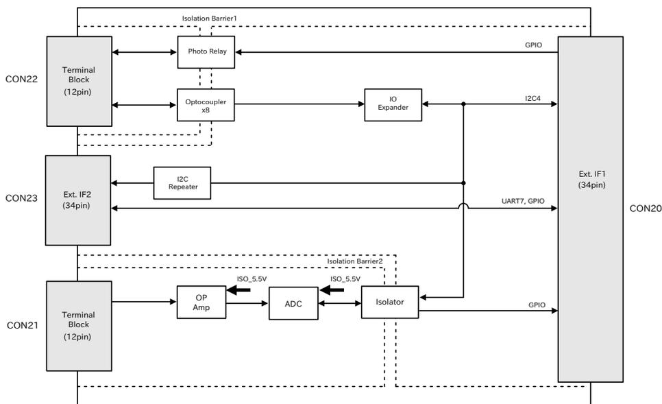
図 6.259 +Di8+Ai4 拡張基板のブロック図
