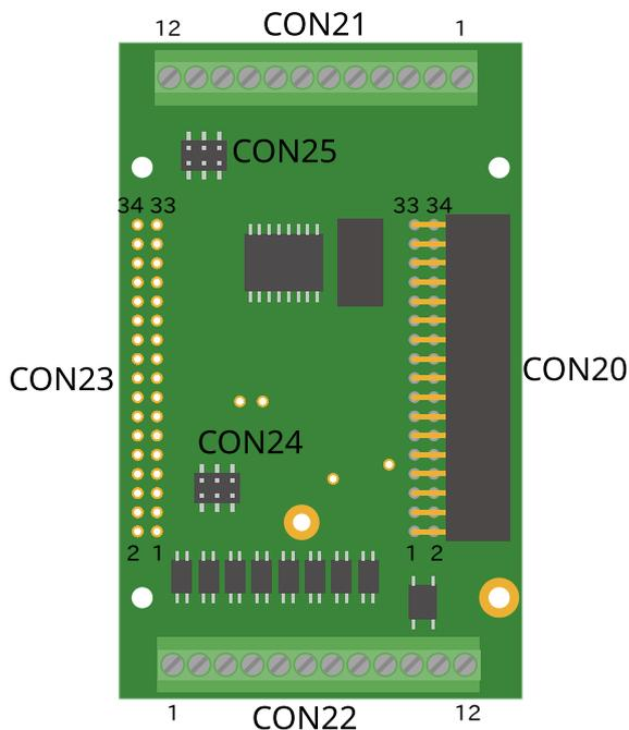
図 6.260 +Di8+Ai4 拡張基板のインターフェースレイアウト
