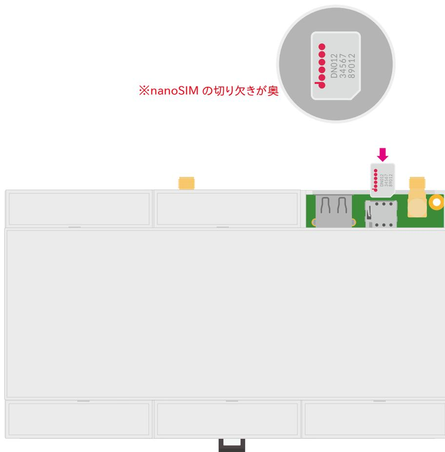
図 3.90 nanoSIM カードの接続例
