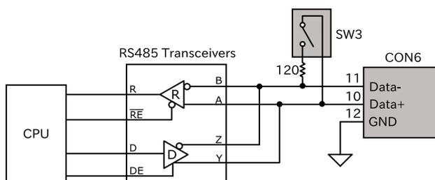
図 3.118 CON6 RS-485 トランシーバ周辺回路
