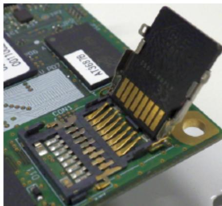
図 3.81 microSD カードの挿抜
