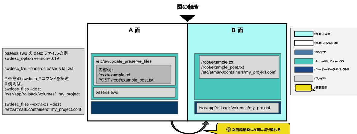
図 6.29 B 面への切り替え (component=base\_os)
