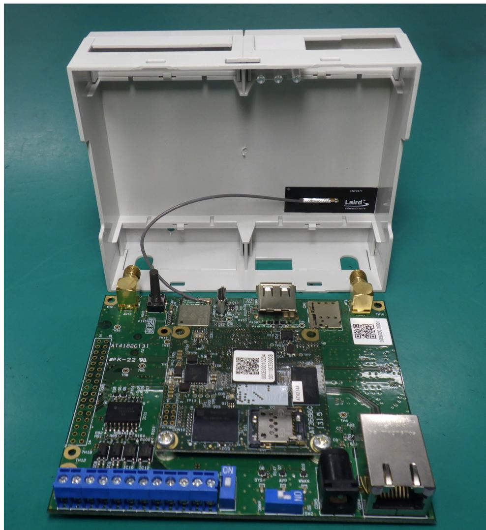
図 3.65 WLAN 基板アンテナの位置
