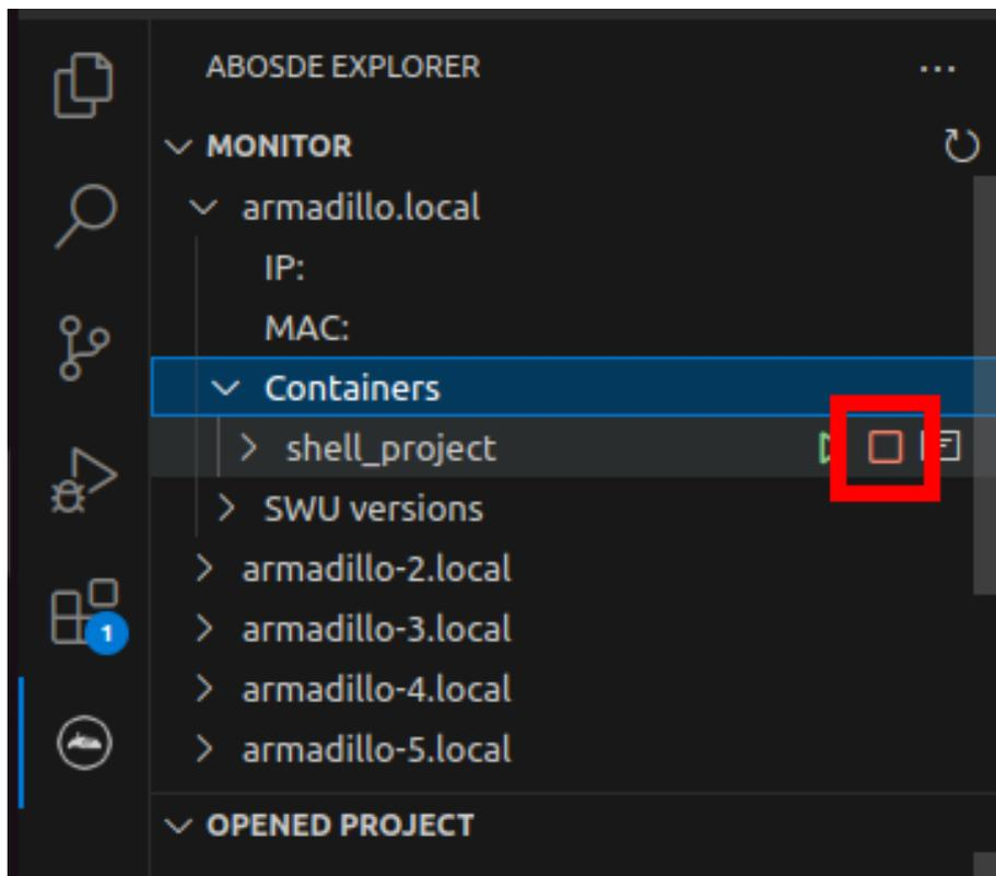
図 6.125 ABOSDE で Armadillo のコンテナを停止
