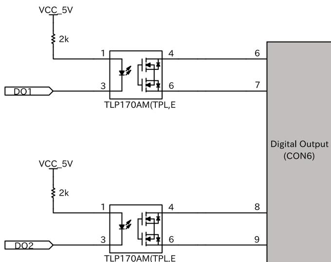
図 3.113 CON6 接点出力周辺回路
