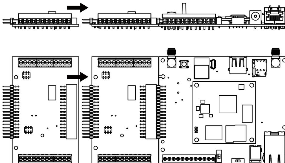
図 3.160 +Di8+Ai4 拡張基板の組付け方法
