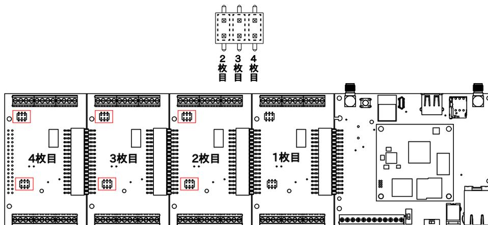
図 3.162 ピンヘッダの位置と設定
