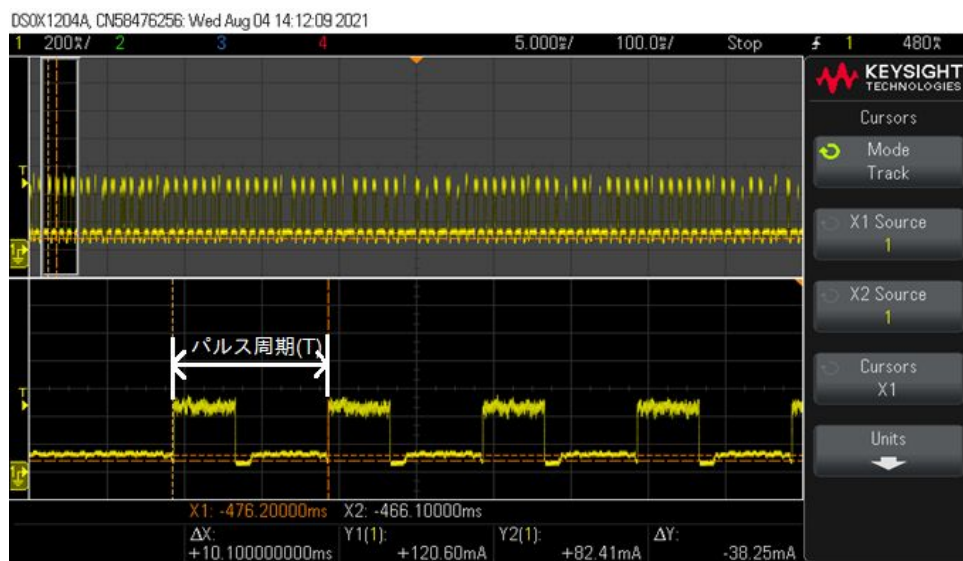
図 5.2 通信中の LTE モジュール消費電流
