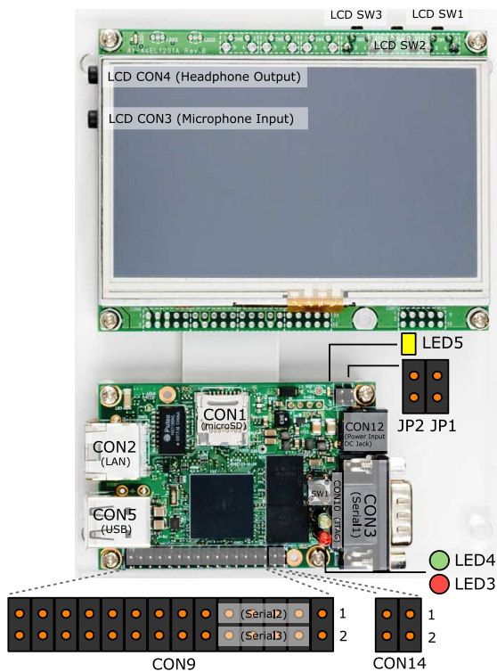
図 3.7 Armadillo-440 液晶モデル見取り図
