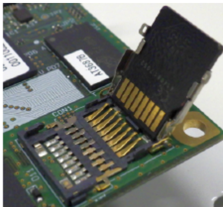
図 5.25 microSD カードの挿抜
