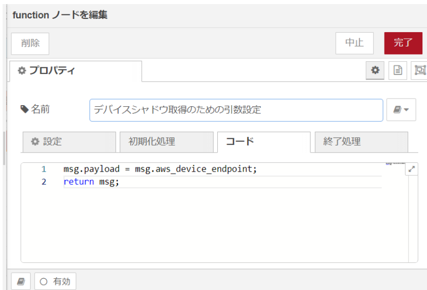
図 4.59 [デバイスシャドウ取得のための引数設定] ノードのプロパティ内容
