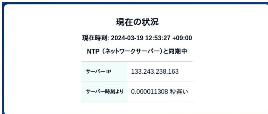
図 6.76 ネットワークタイムサーバーと同期されている場合の状況確認画面
