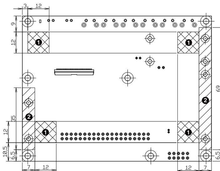
図 6.177 LCD 拡張ボードの両面テープと固定部品配置可能位置
