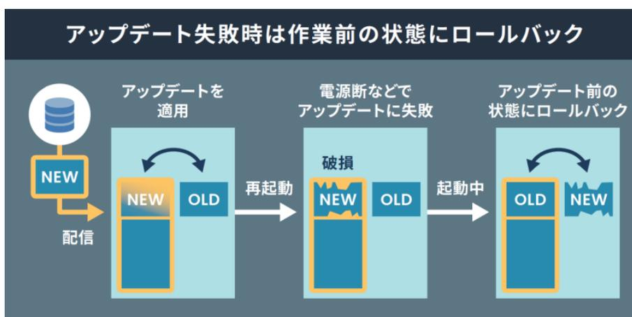
図 2.5 ロールバックの仕組み
