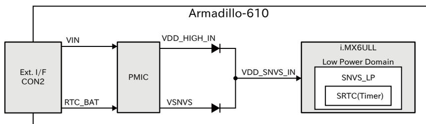
図 6.154 バックアップ電源供給回路
