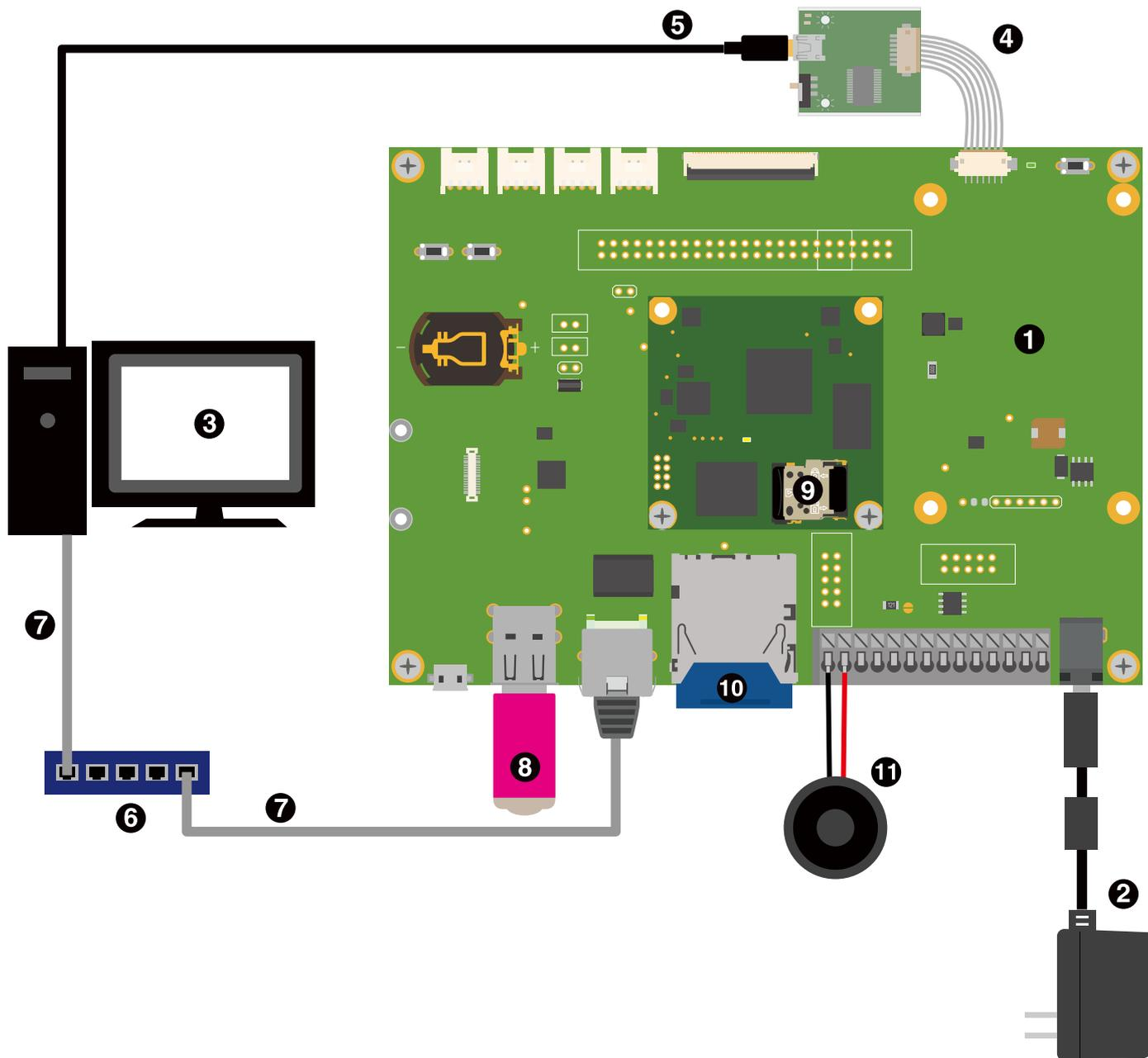
図 3.15 Armadillo-610 開発セットの接続例
