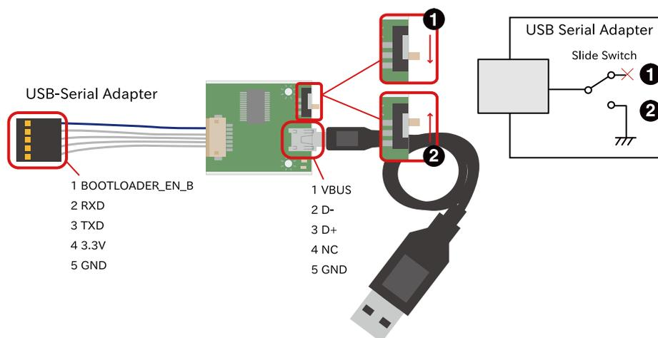
図 6.132 USB シリアル変換アダプタの配線
