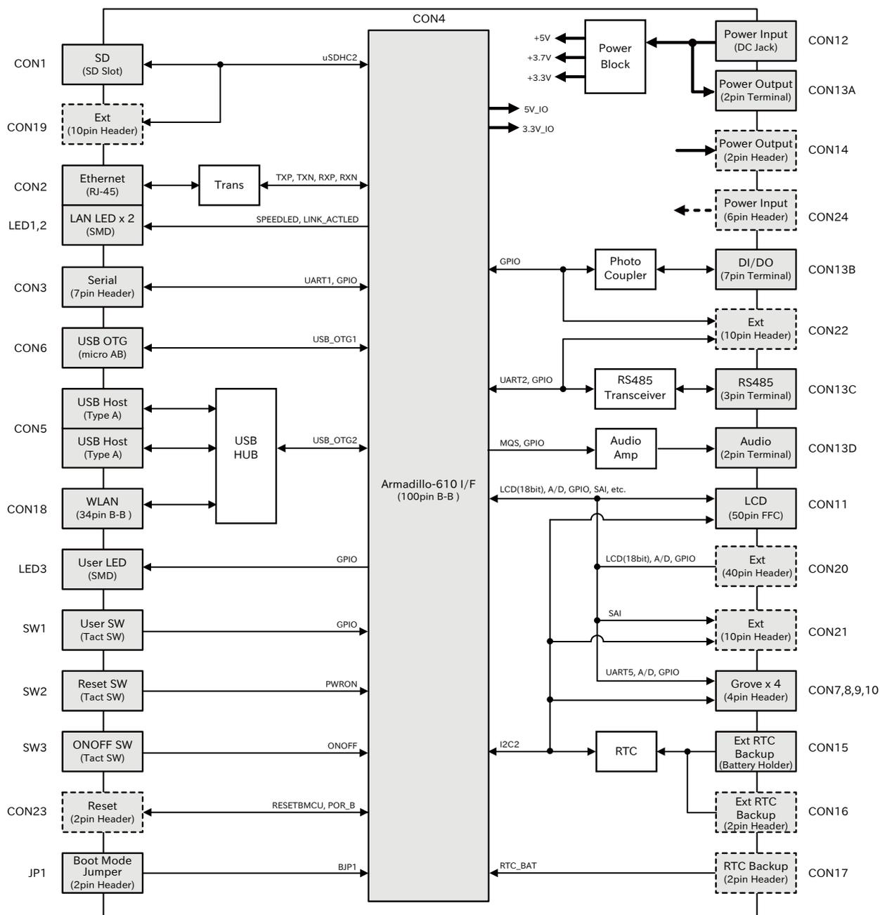
図 6.133 Armadillo-610 拡張ボードのブロック図
