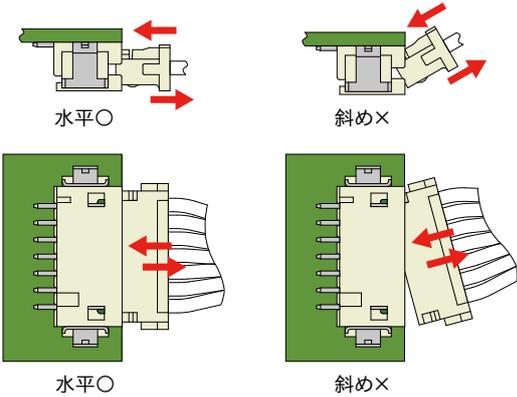
**図 6.138 USB シリアル変換アダプタの挿抜角度**
