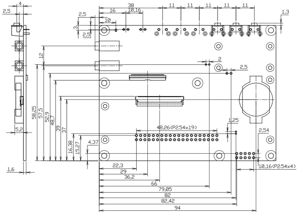
図 6.178 LCD 拡張ボードのコンネクタ位置寸法
