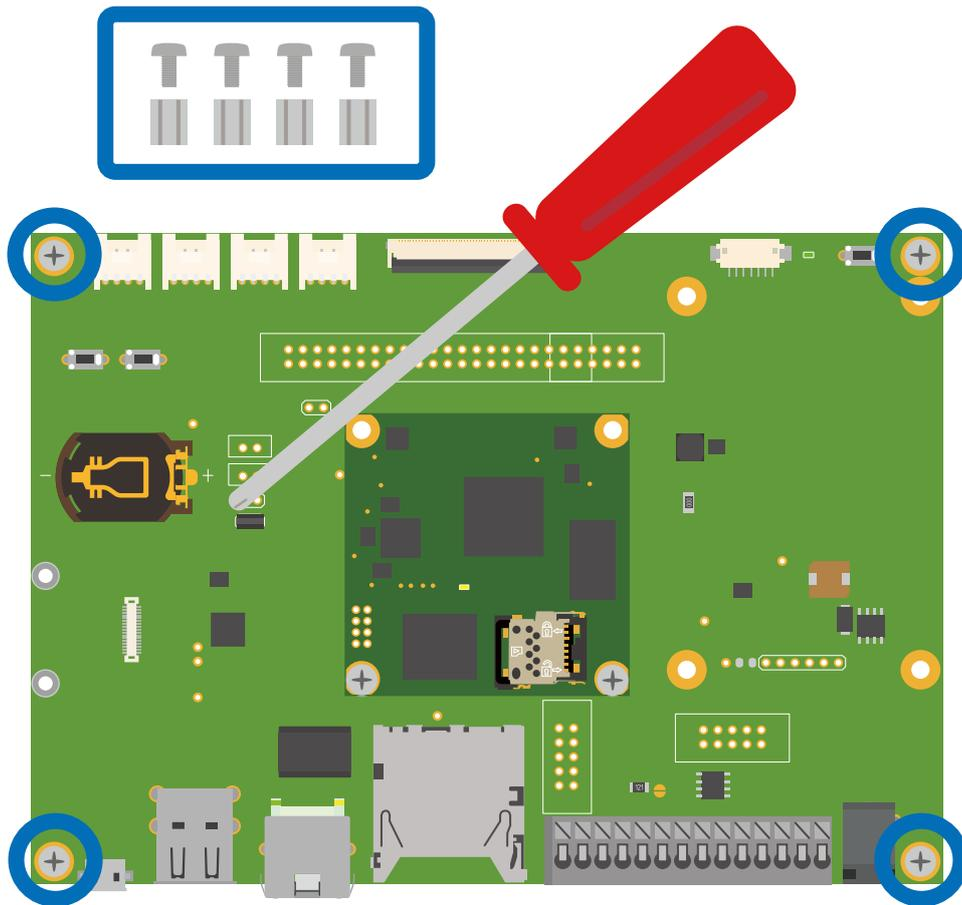
図 3.4 Armadillo-610 開発セットの組み立て
