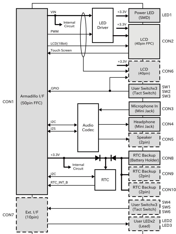
図 6.170 LCD 拡張ボードのブロック図
