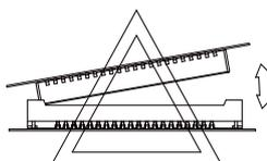
コネクタが損傷する可能性が高いため、コネクタのコーナー方向や幅の広い方向から斜めに抜去しないでください。
