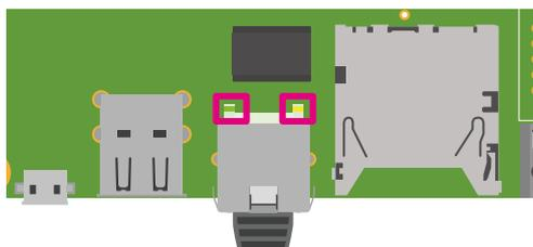
図 6.166 Armadillo-610 拡張ボード LED1、LED2
