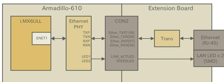
図 3.31 LAN(Ethernet)接続例
