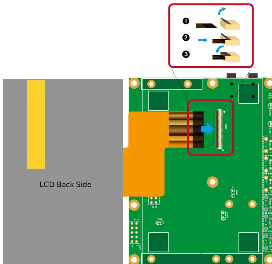
図 6.172 タッチパネル LCD と LCD 拡張ボードの接続
