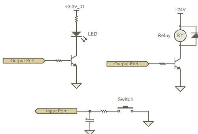
図 3.36 スイッチ、LED、リレー接続例
