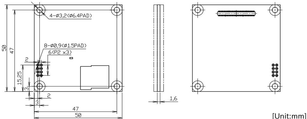
図 3.47 基板形状および固定穴寸法
