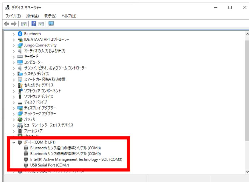
図 3.19 Bluetooth に割当の COM を変更した状態
