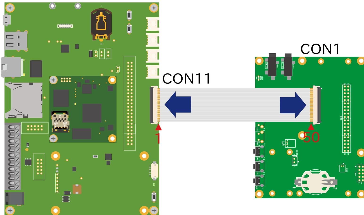
図 6.174 Armadillo-610 と LCD 拡張ボードの接続
