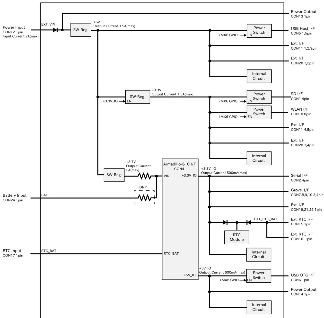
図 6.134 Armadillo-610 拡張ボードの電源回路の構成
