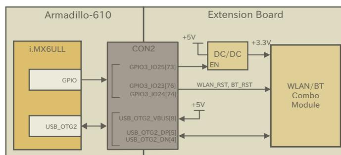
図 3.32 WLAN/BT 接続例
