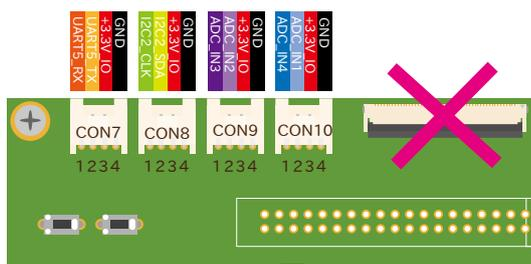
図 6.143 Armadillo-610 拡張ボード CON7、CON8、CON9、CON10
