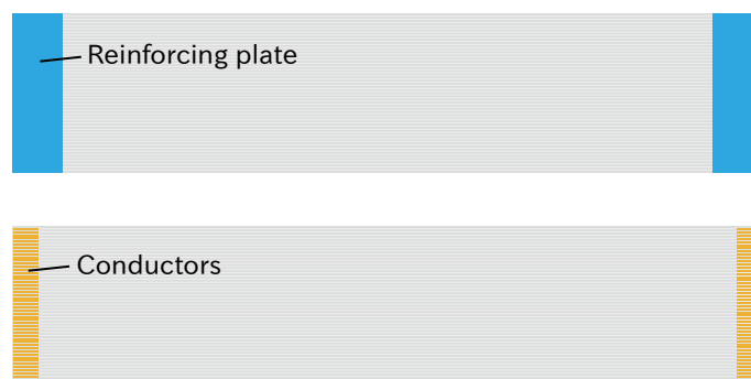
図 3.127 フレキシブルフラットケーブルの形状
