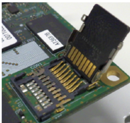
図 3.67 microSD カードの挿抜
