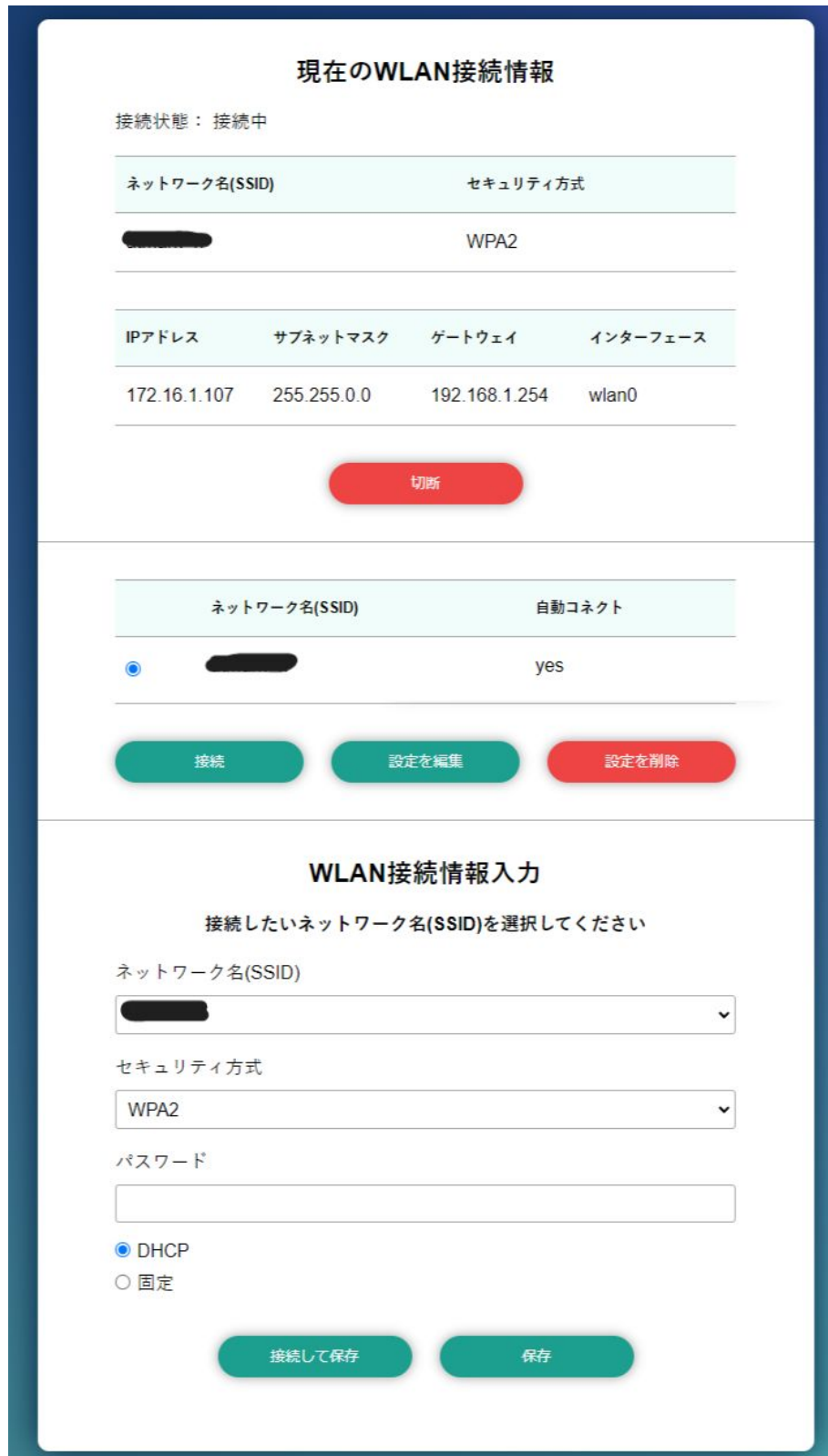
図 3.113 WLAN クライアント設定画面
