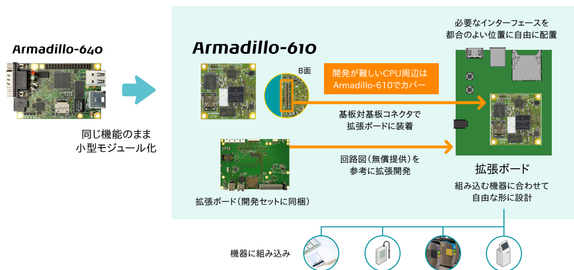
図 3.2 拡張ボードの例
