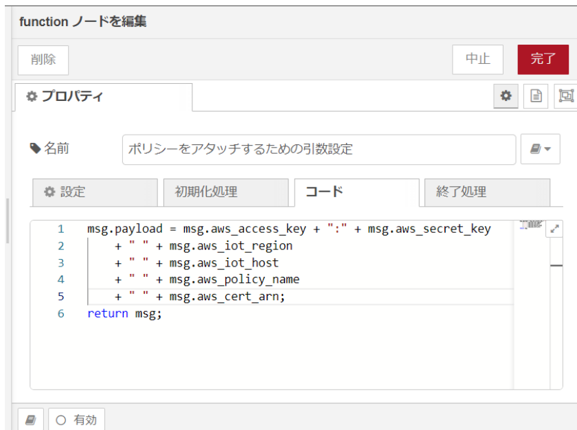
図 4.55 [ポリシーをアタッチするための引数設定] ノードのプロパティ内容
