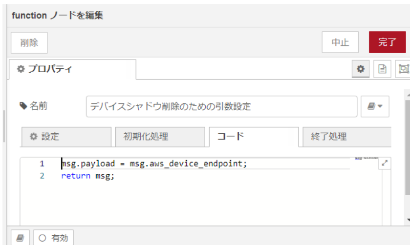
図 4.71 [デバイスシャドウ削除のための引数設定] ノードのプロパティ内容
