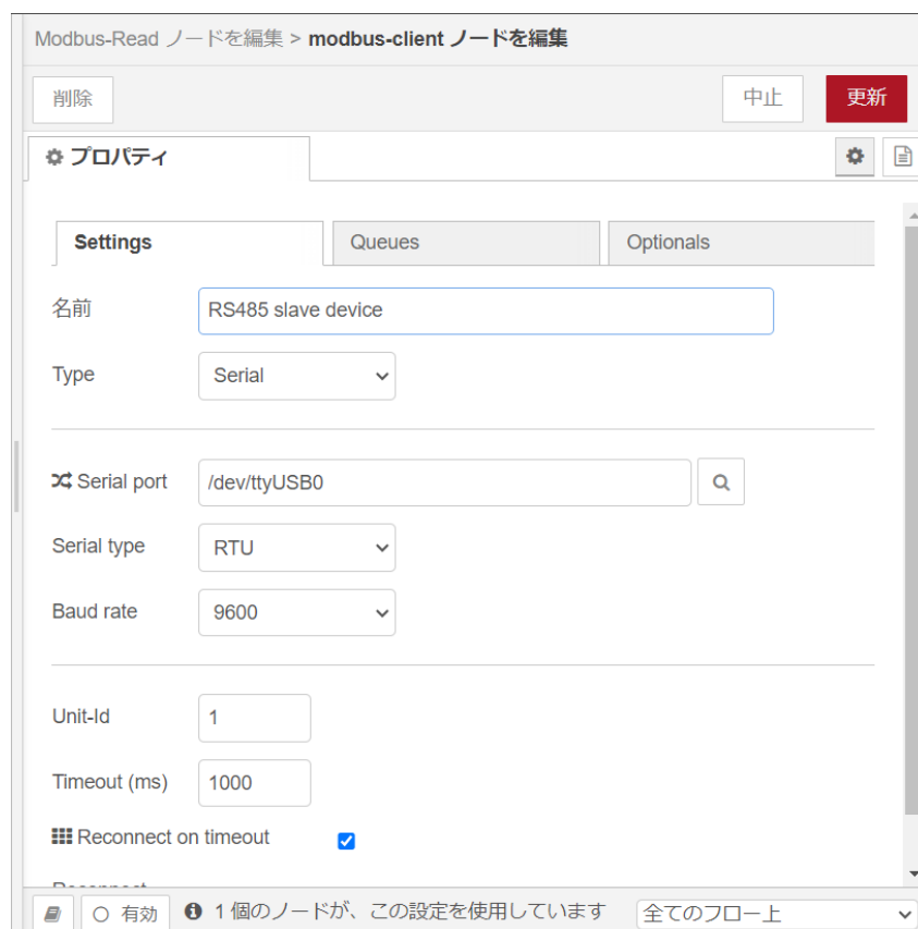
図 4.12 [modbus-client] ノードのプロパティ内容
