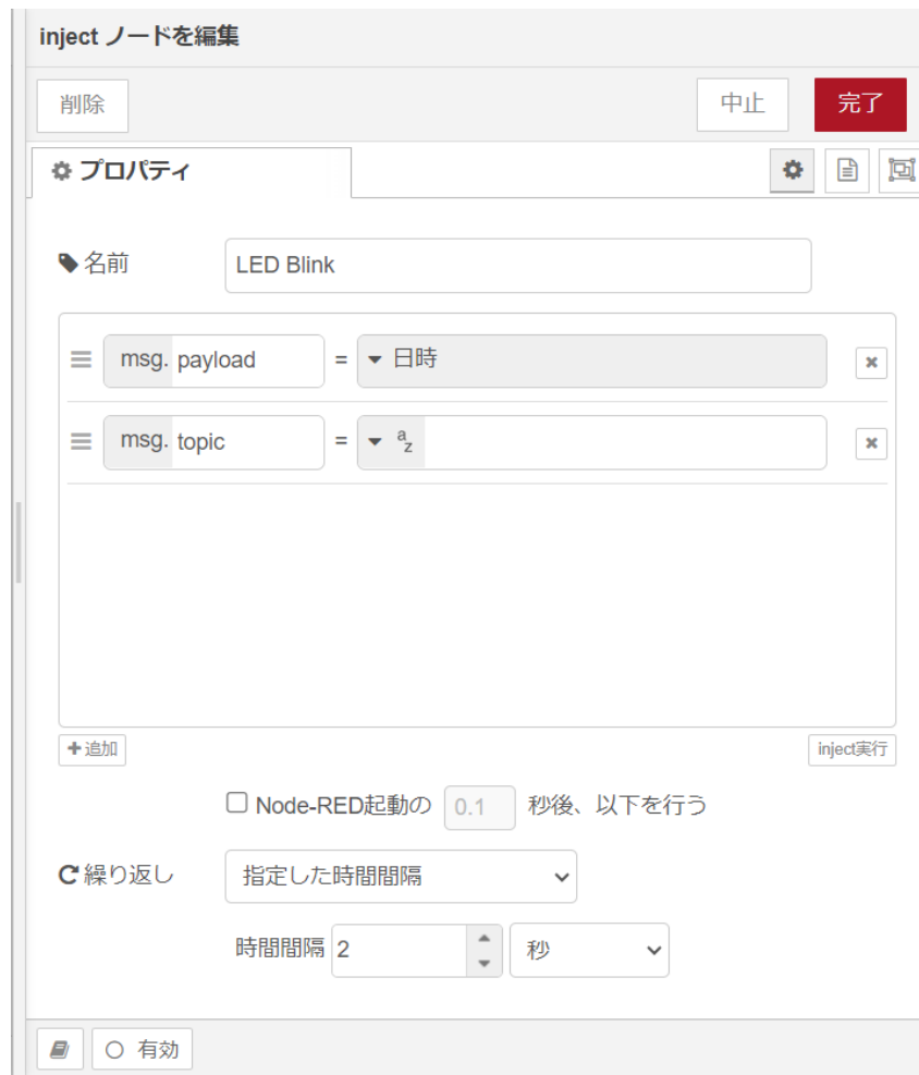
図 4.4 [inject] ノードのプロパティ内容
