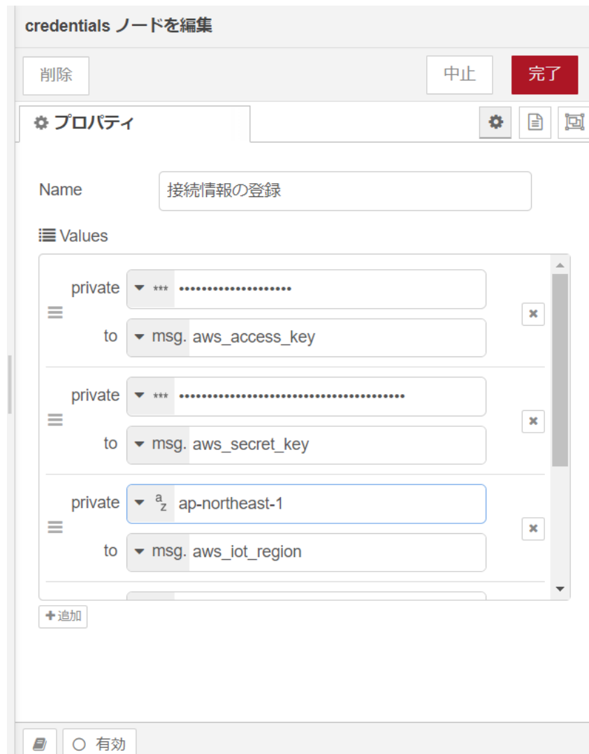
図 4.37 [接続情報の登録] ノードのプロパティ内容
