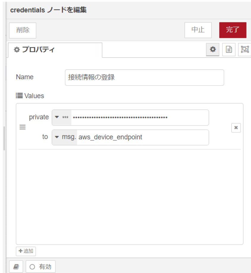
図 4.65 [接続情報の登録] ノードのプロパティ内容
