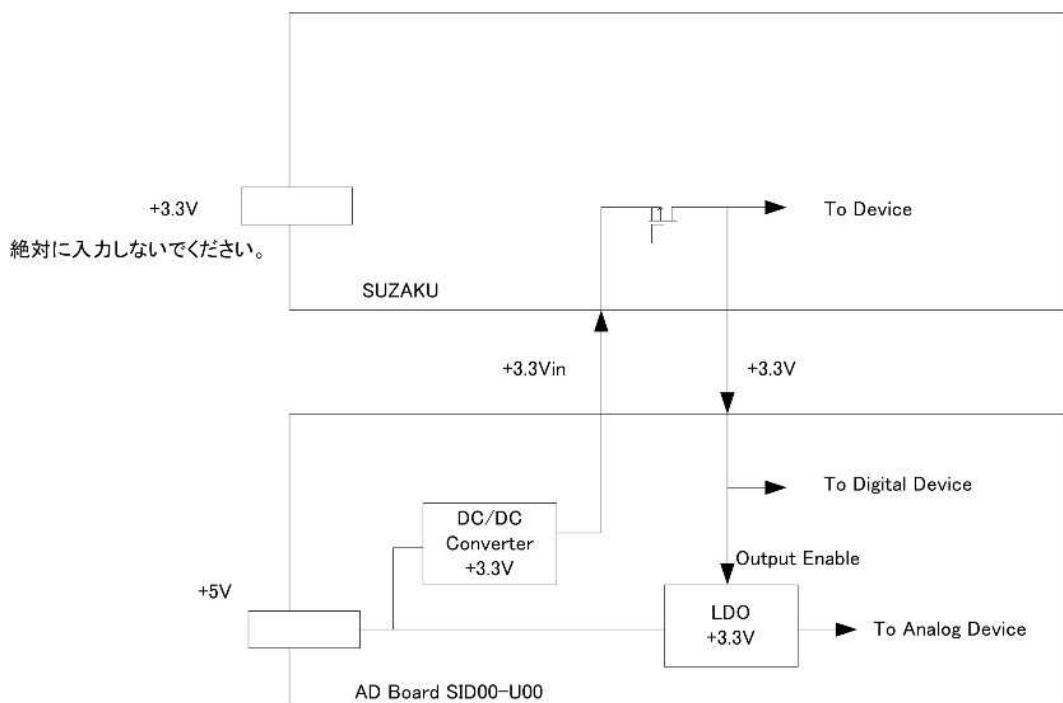
図 7.1. 電源系統図
