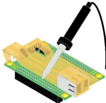
図 6.3. 半田付け時のマスキング処理
