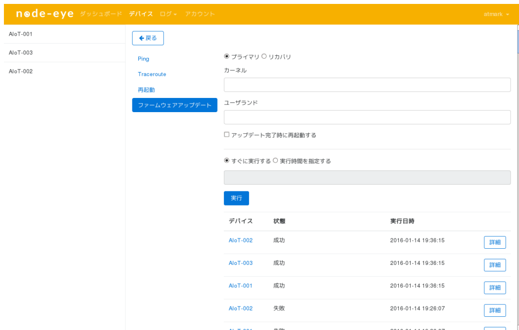
図 3.8 ファームウェアアップデート (node-eye コントロールパネル)
