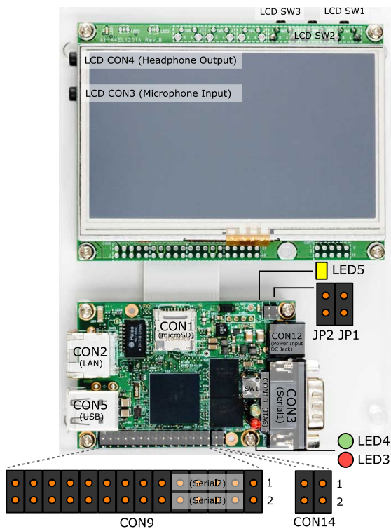
図 3.5 Armadillo-440 液晶モデル見取り図
