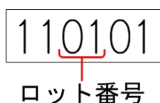
図 1.16 Armadillo-400 シリーズ WLAN インターフェイスボードのロットシールフォーマット
