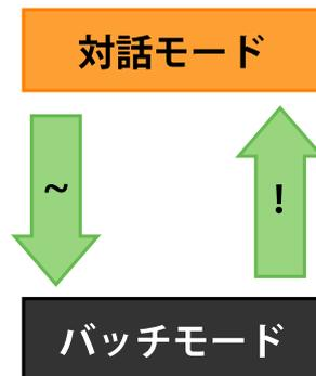
Hermit-AT ダウンローダと通信を行った場合は、バッチモードに移行します。これは通信を確立するために Hermit-AT ダウンローダがチルダを送信するためです。
